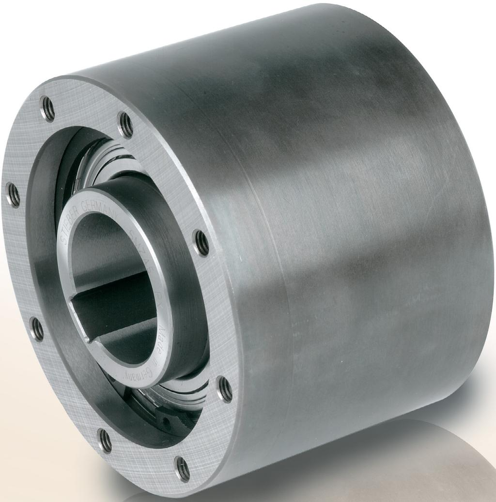
SMZ 型超越离合器是多边形楔块接触式超越离合器，两侧支撑轴承采用带油脂及密封盖的60...ZZ型深沟球轴承，为便于客户安装，该超越离合器出厂时已经加注了润滑脂。SMZ 型超越离合器的用途较多，后面一页有其典型的安装布置图，可供参考。
