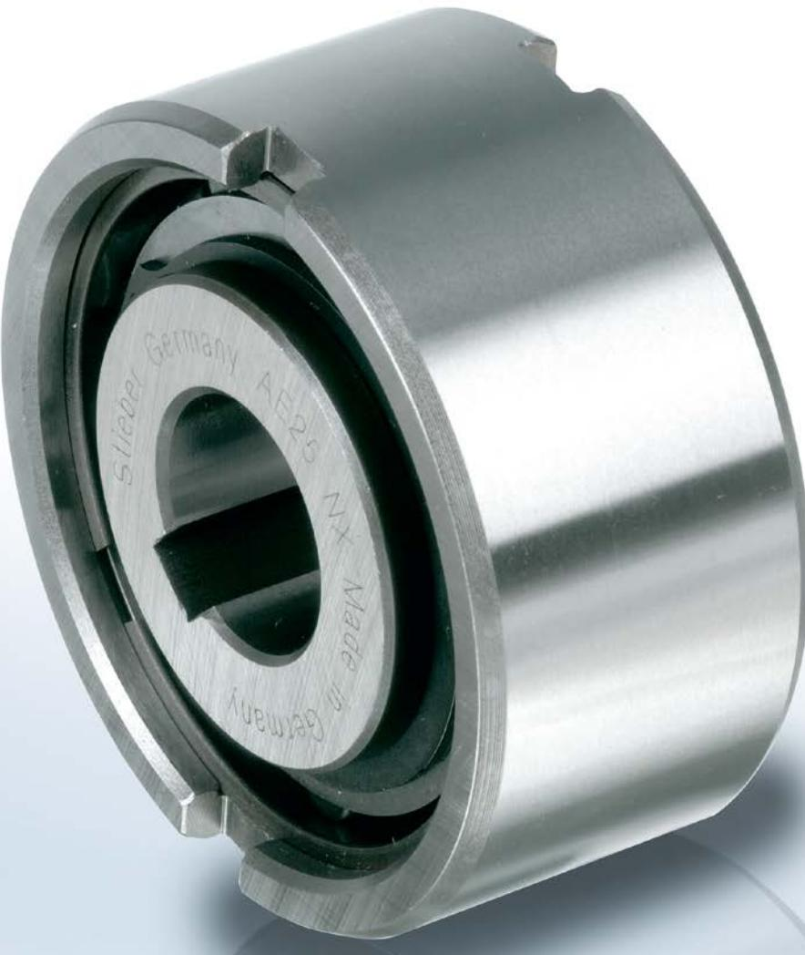
Die Bauart AE ist ein ungelagerter Rollenfreilauf. Auf eine einwandfreie Lagerung, Schmierung und Abdichtung des Freilaufes ist zu achten.
