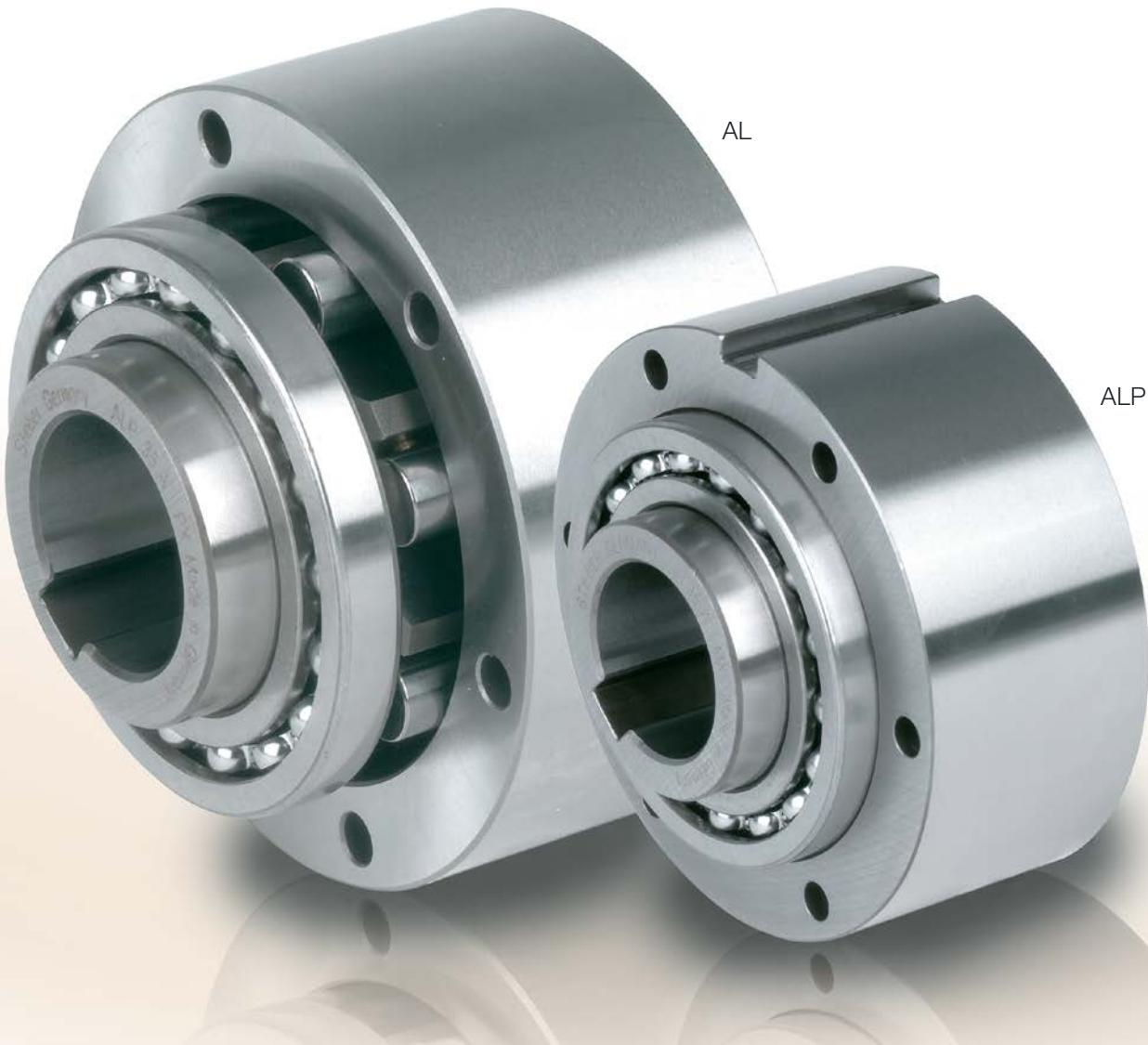
Die Bauarten AL und ALP sind Klemmrollenfreiläufe. Es sind gelagerte Grundeinheiten mit zwei Kugellagern der Reihe 160.. Standardmäßig muss eine Ölschmierung vorgesehen werden. Vorzugsweise werden diese Freiläufe im Gehäuse eingebaut, wo bereits Schmierung und Abdichtung vorhanden sind.
