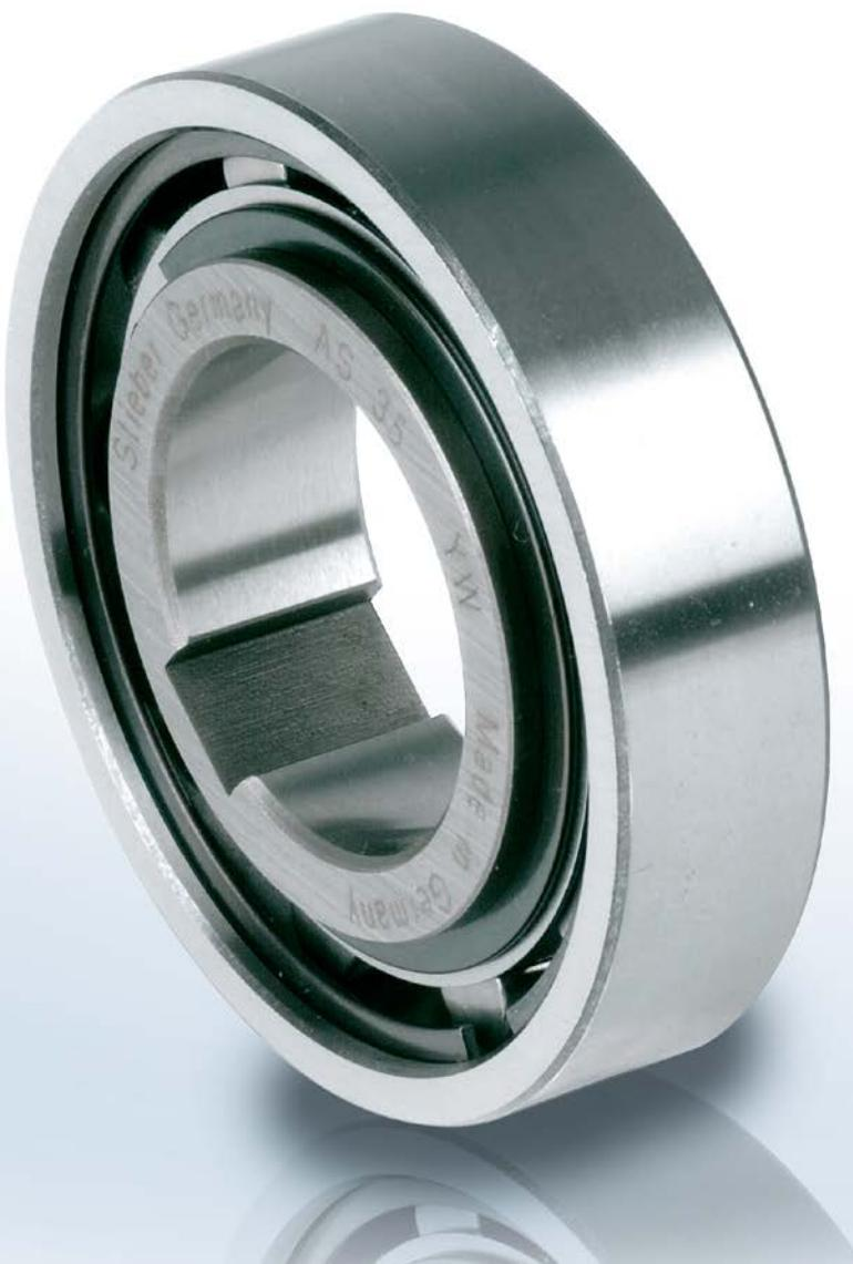
Die Bauart AS ist ein ungelagerter Rollenfreilauf. Auf eine einwandfreie Lagerung, Schmierung und Abdichtung des Freilaufes ist zu achten. Die Einbaumaße entsprechen der Kugellagerreihe 62..
