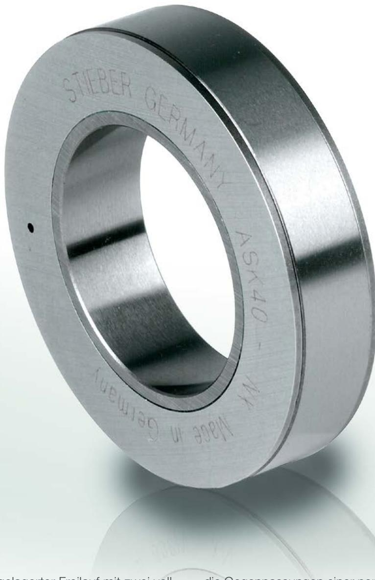
Die Bauart ASK ist ein gelagerter Freilauf mit zwei vollrolligen Lagerreihen. Er ist staubgeschützt und mit einer Fettschmierung versehen.
