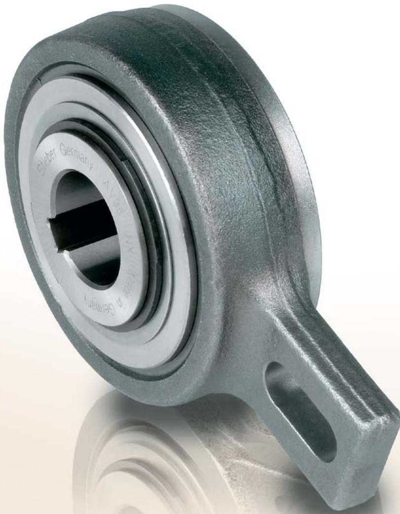
Die Bauart AV ist ein Klemmrollenfreilauf. Er ist gleitgelagert und für niedrige Drehzahlen geeignet. Das Drehmoment ist bei geringem Bauraum sehr hoch. Der Freilauf wird mit Fettschmierung geliefert; die Abdichtung erfolgt mit Labyrinthringen. Er wird montagefertig geliefert für den Einbau in horizontaler oder vertikaler Lage. Diese Bauart wird vornehmlich als Rücklaufsperrre eingesetzt. Sie ist besonders geeignet für die Verwendung unter schwierigen Umgebungseinflüssen (Staub, grober Schmutz).
