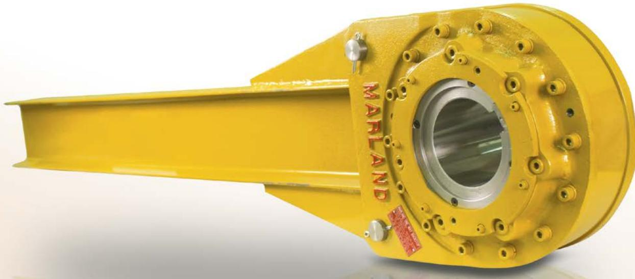
Die Bauart BC MA ist ein abgedichteter, montagefertiger Rollenfreilauf, der gelagert ist. Standardmäßig muss eine Ölschmierung vorgesehen werden. Diese Rücklausperre wird überwiegend an der Antriebstrommelwelle von großen Schrägförderbändern eingesetzt.
