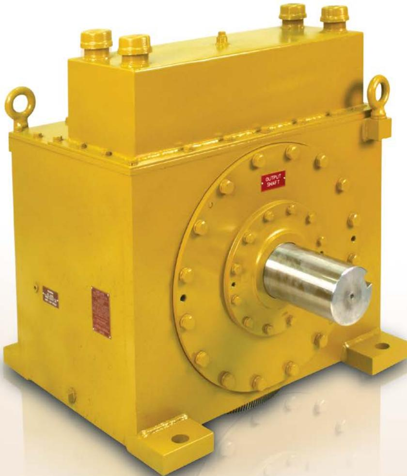
Die Bauart CEUS aus der Produktgruppe CECON ist ein gelagerter Klemmrollenfreilauf, der in einem Gehäuse eingebaut ist. Ölschmierung ist vorgeschrieben. Dieser Gehäusefreilauf wird für wechselweise arbeitende Zweimotoren-Antriebe eingesetzt (Gebläse, Turbinen, Pumpen). Das Gehäuse mit optimierter Kühlfläche und großem Ölvolume bietet hohe Sicherheit bei kontinuierlich laufenden Anlagen ohne Überwachung.
