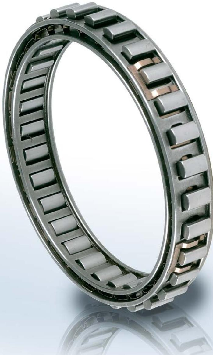
Die Bauart DC ist ein Klemmkörperkäfigfreilauf ohne Innen- und Außenring. Der Einbau erfolgt zwischen zwei konzentrischen Laufbahnen oder Ringen, die zueinander gelagert werden müssen. Schmierung und Abdichtung sind vorzusehen. DC-Freiläufe der Ausführung-N sind für alle in der Antriebstechnik üblichen Schmiermittel geeignet.
