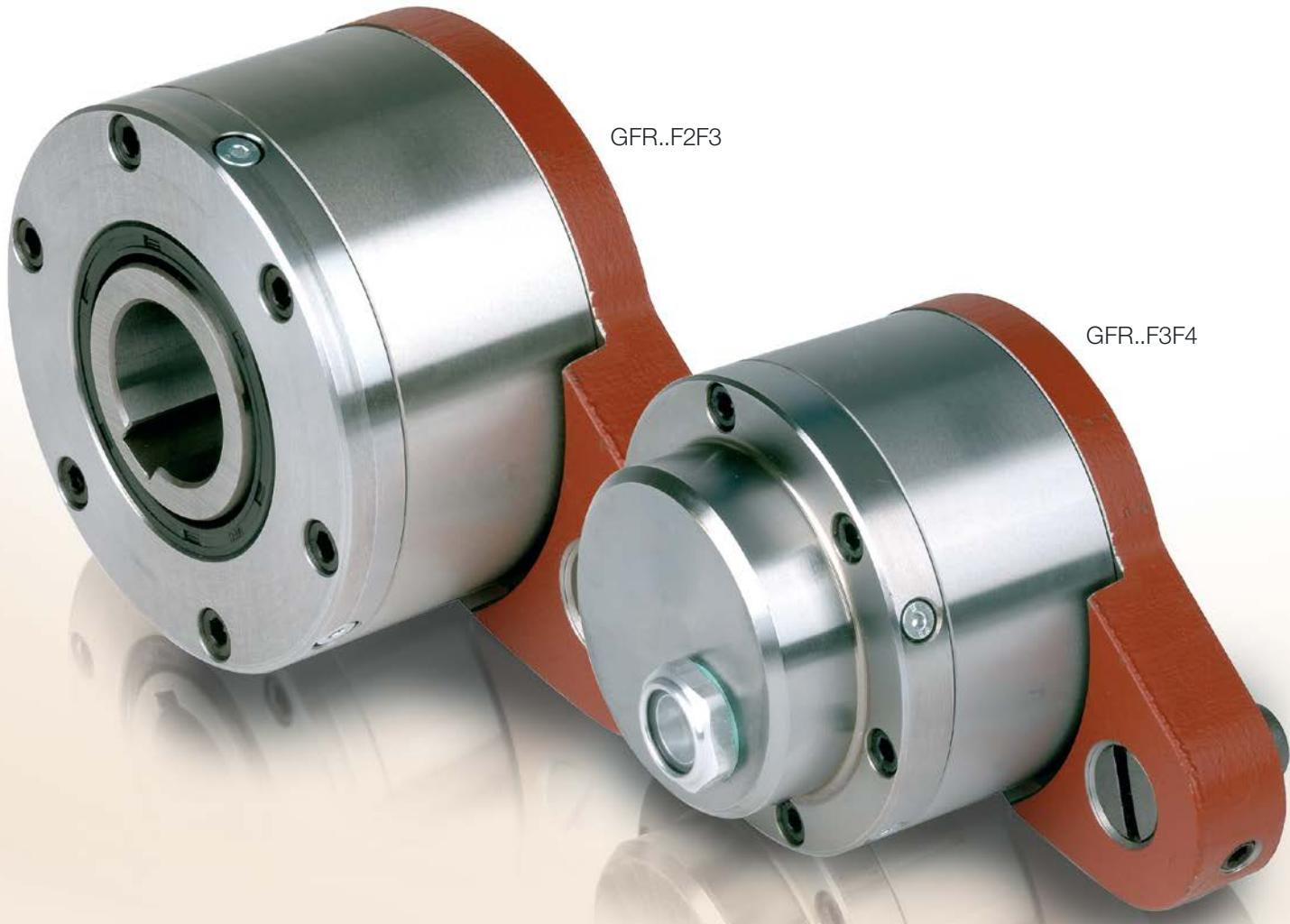
Die Bauarten GFR..F2F3/F3F4 sind abgedichtete, montagefertige Rollenfreiläufe, gelagert mit zwei Kugellagern der Reihe 160.
