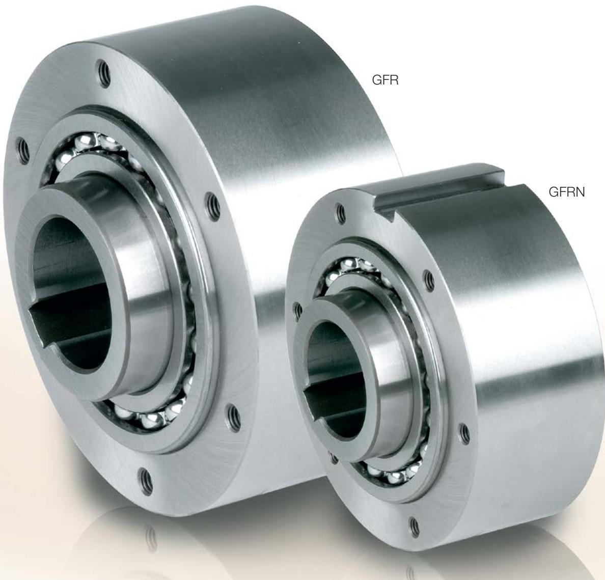
Die Bauarten GFR und GFRN sind Klemmrollenfreiläufe. Es sind gelagerte Grundeinheiten mit zwei Kugellagern der Reihe 160.. Standardmäßig muss eine Ölschmierung vorgesehen werden. Vorzugsweise werden diese Freiläufe im Gehäuse eingebaut, wo bereits Schmierung und Abdichtung vorhanden sind.
