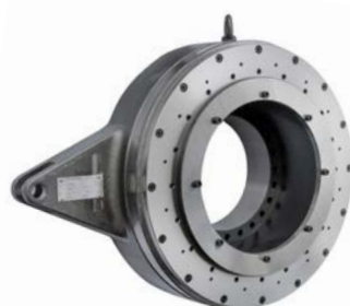
Nachrüstung bestehender langsam laufender Rücklaufsperren im Kohletagebau
