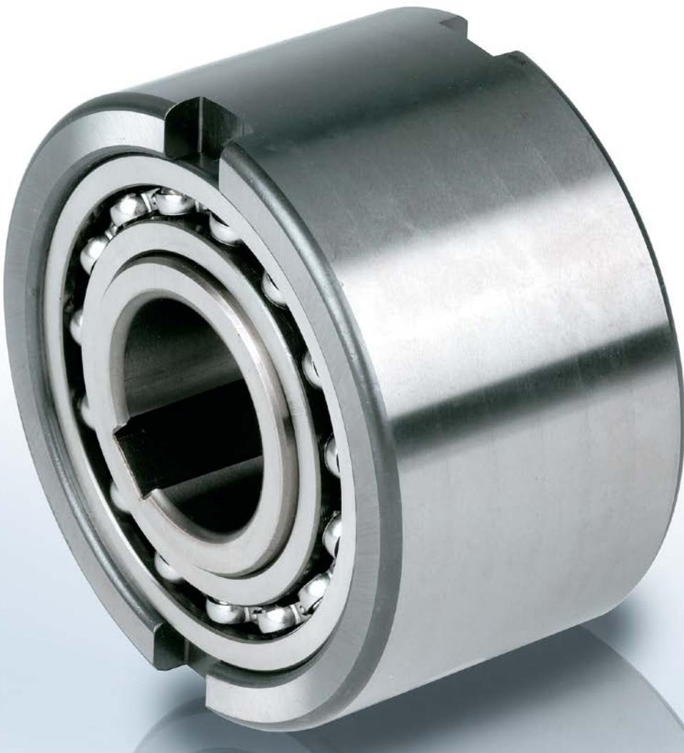
Die Bauart NFR ist ein gelagerter Klemmrollenfreilauf ohne Abdichtung. Abdichtung und Schmierung sind vorzusehen; empfohlen wird Ölschmierung.
