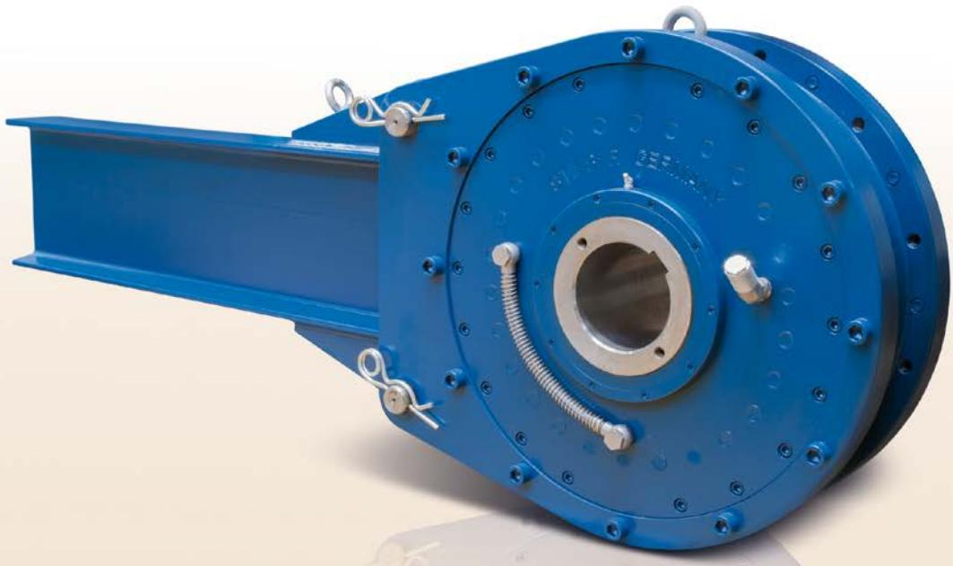
Rücklaufsperren der Bauart RDBR-E werden überwiegend direkt auf die Antriebswelle von Förderbändern, Mischtrommelantrieben oder Kettenförderern montiert, wenn eine Drehmomentbegrenzung / Lastverteilung oder Lösemöglichkeit erforderlich ist.
