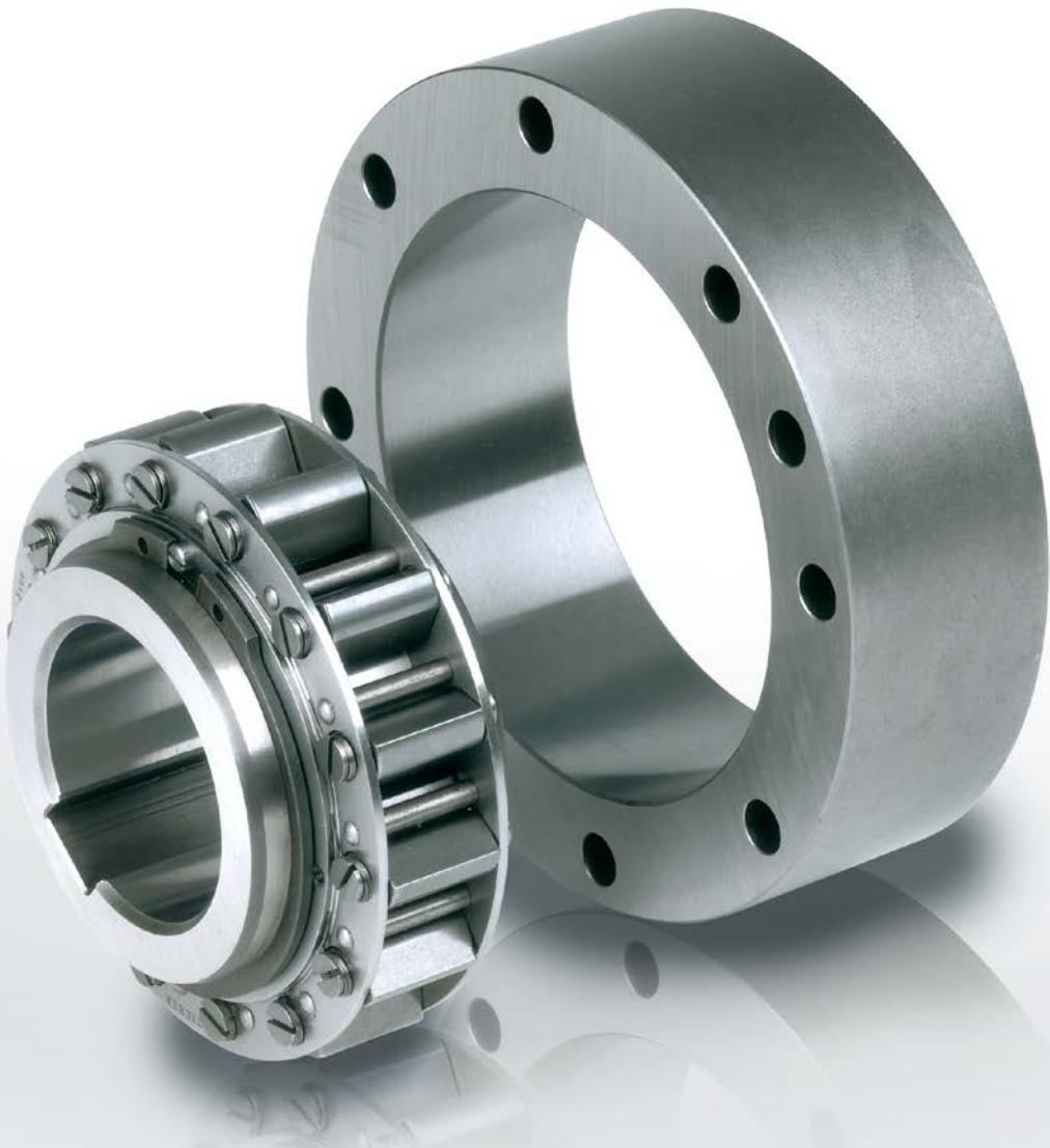
Die Bauart RSCI ist ein fliehkraftabhebender Klemmkörperfreilauf bei drehendem Innenring. Nur dieser Ring ist für die Überholbewegung geeignet.
