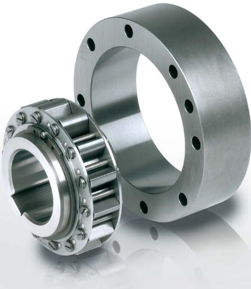
Die Bauart RSCI ist ein fliehkraftabhebender Klemmkörperfreirauf bei drehendem Innenring. Nur dieser Ring ist für die Überholbewegung geeignet. Der Freilauf ist ungelagert. Es müssen Lager vorgesehen werden, welche die Konzentrität der Ringe gewährleisten und Radial- und Axialkräfte aufnehmen. Rund- und Planlauffehler müssen innerhalb der angegebenen Toleranzen liegen.
