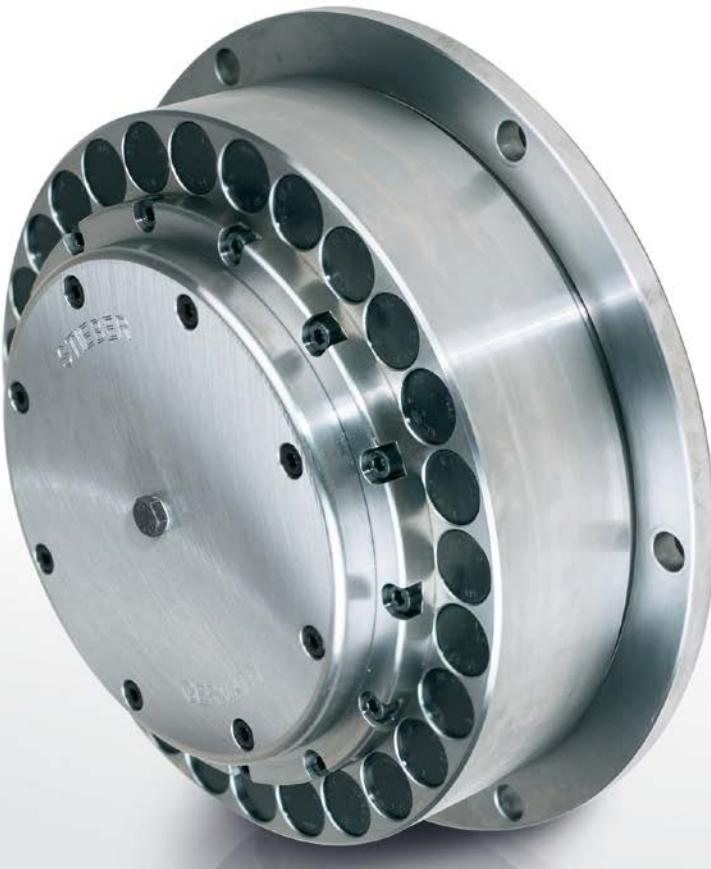
Bei den Bauarten RSRV und RSRT handelt es sich um fliehkraftabhebende RSCI – Klemmkörperfreiläufe (» siehe Seiten 72 bis 75), die zusätzlich mit einer kraftschlüssigen Drehmomentbegrenzung ausgestattet sind. Diese begrenzt das übertragene Drehmoment auf einen Maximalwert, der werkseitig eingestellt wird. Die Verwendung von speziellen, ölgetränkten Reibbelägen gewährleistet eine gleichbleibende Drehmomentgrenze, auch nach langer Stillstandzeit.
