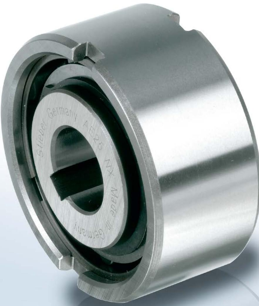
El modelo AA es una rueda libre de tipo rodillo que no se coloca sobre rodamientos. Los rodamientos son necesarios para soportar las cargas axiales y radiales. La lubricación y el sellado también deben proporcionarse en la instalación.
