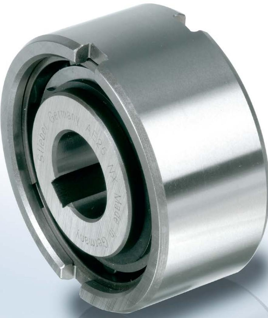
El modelo AE es una rueda libre de tipo rodillo que no se coloca sobre rodamientos. Los rodamientos son necesarios para soportar las cargas axiales y radiales. La lubricación y el sellado también deben proporcionarse en la instalación. El diámetro exterior nominal es una dimensión de rodamiento de bola estándar.
