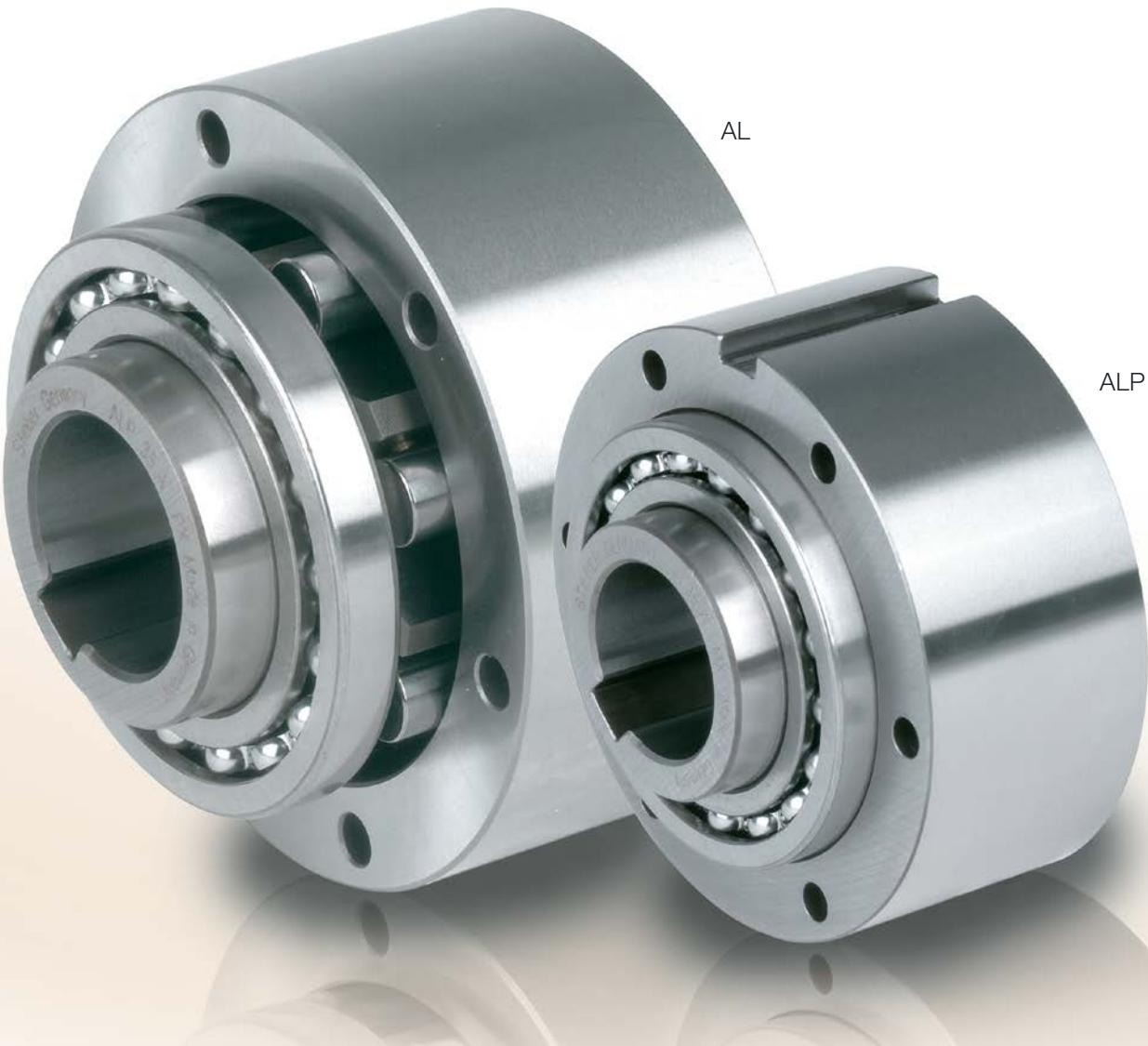
Los modelos AL y ALP son ruedas libres de tipo rodillo. Estas unidades forman parte del sistema modular Stieber. Se colocan sobre rodamientos, utilizando dos rodamientos de la serie 160., y requieren lubricación con aceite. Estas unidades pueden utilizarse en diseños que proporcionen lubricación con aceite y sellado, como se muestra en la página siguiente.
