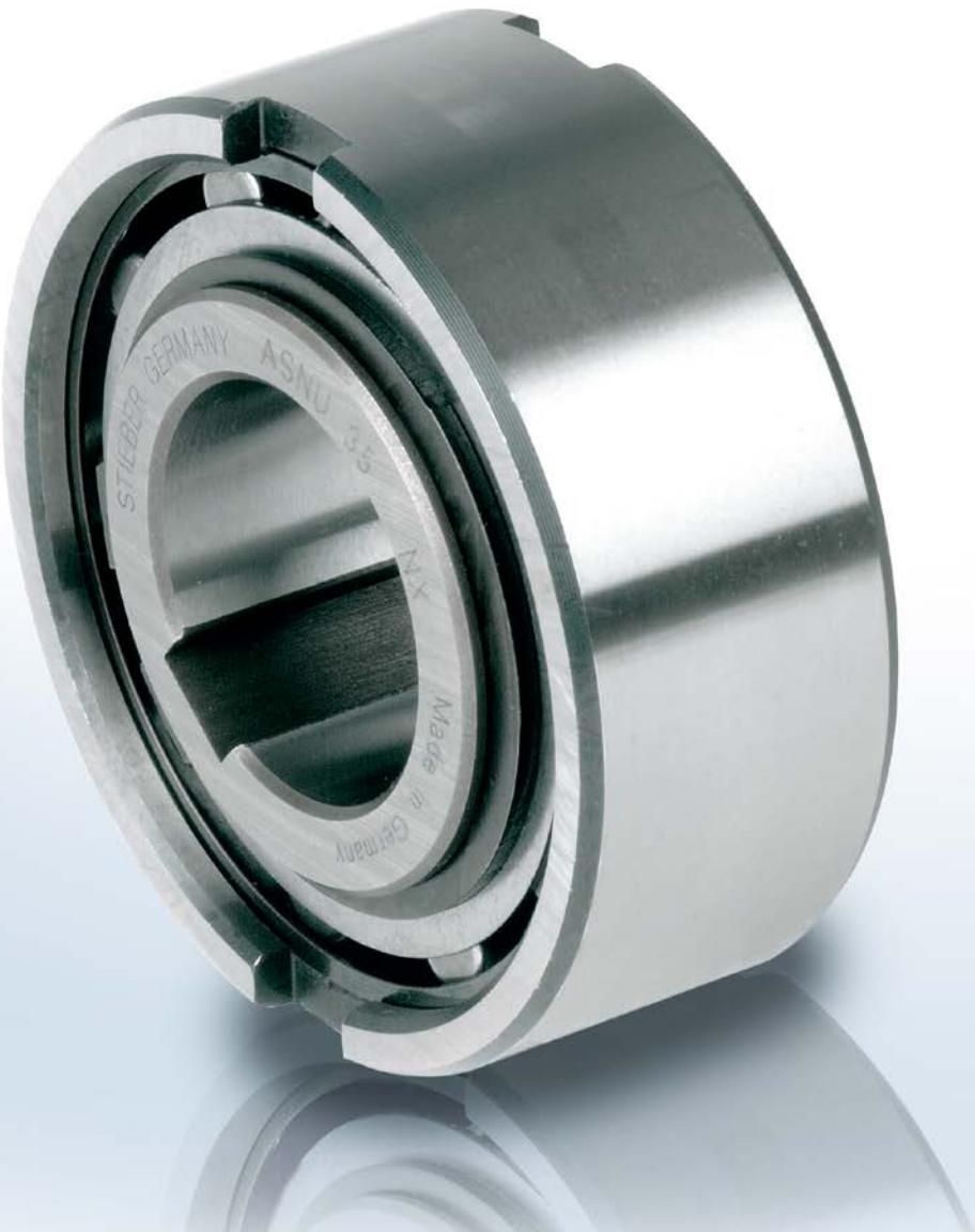
El modelo ASNU es una rueda libre de tipo rodillo que no se coloca sobre rodamientos. Los rodamientos son necesarios para soportar las cargas axiales y radiales. La lubricación y el sellado también deben proporcionarse en la instalación. El diámetro externo nominal es el mismo que el de un rodamiento de bola de la serie 63...
