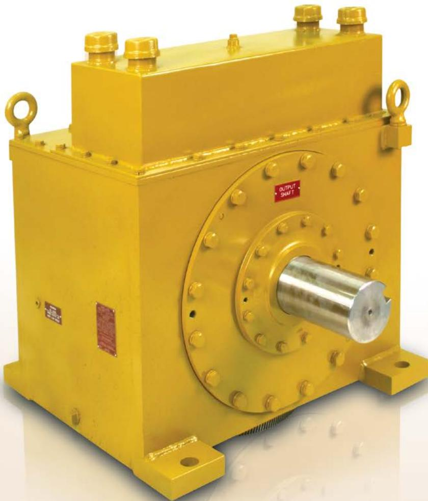
El modelo CEUS del grupo de productos CECON es un embrague unidireccional de tipo rodillo, autónomo, que se coloca sobre rodamientos en una carcasa de hierro fundido. El método de lubricación estándar es aceite.
