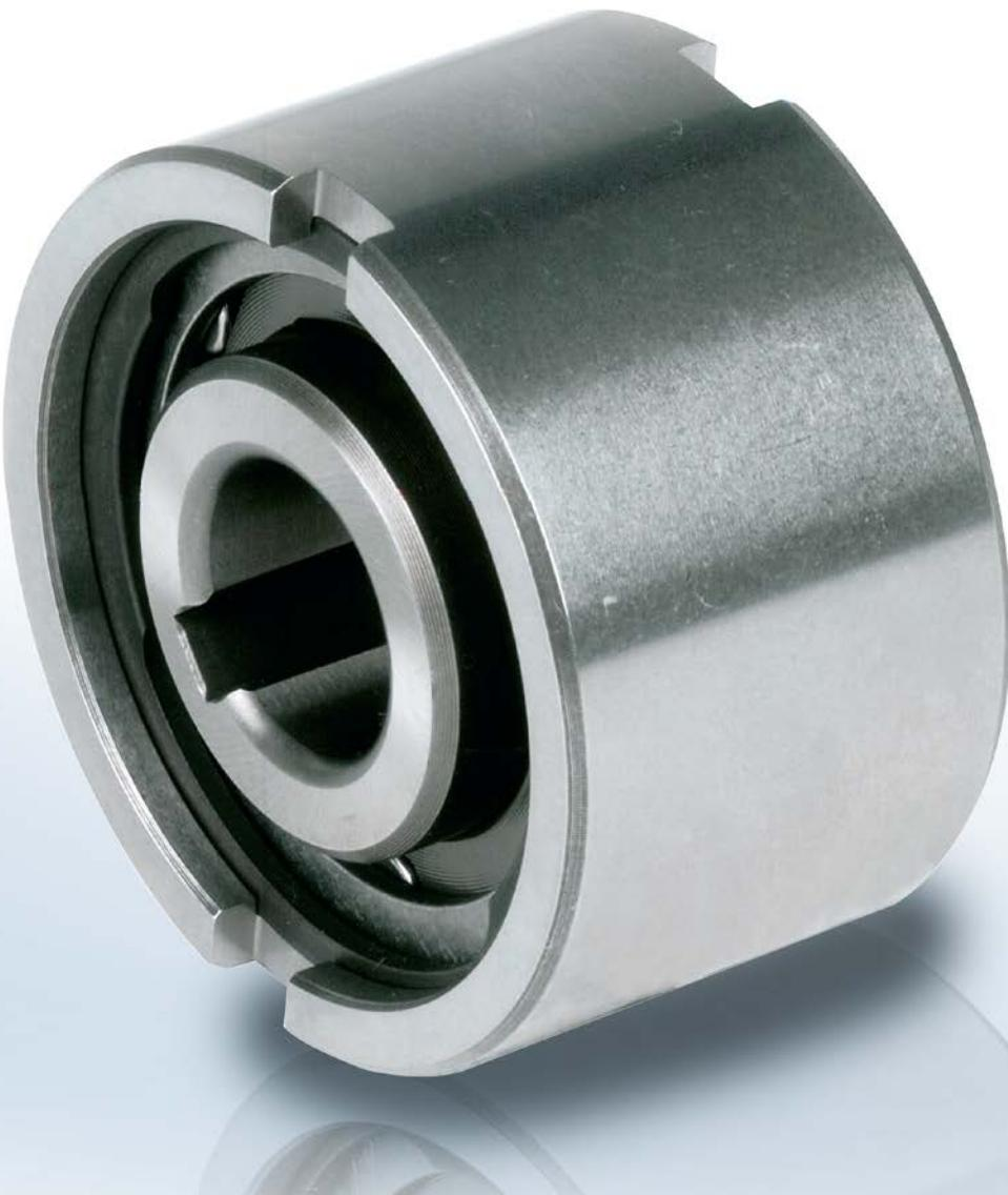
El modelo NF es una rueda libre de tipo rodillo que no se coloca sobre rodamientos. Los rodamientos son necesarios para soportar las cargas axiales y radiales. La lubricación y el sellado también deben proporcionarse en la instalación.
