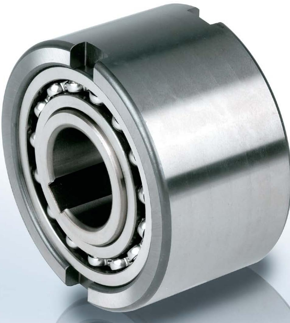
El modelo NFR es una rueda libre de tipo rodillo sin sellado que se coloca sobre rodamientos. La lubricación y el sellado deben proporcionarse en la instalación. El método de lubricación estándar es aceite. Las unidades de tamaño de 8 a 20 utilizan un soporte de rodamiento de acero sobre acero desde la pista interna. Por encima del tamaño 25, se utilizan dos rodamientos de bola de la serie 160.., proporcionando una mayor capacidad de velocidad de sobremarcha. En la página
