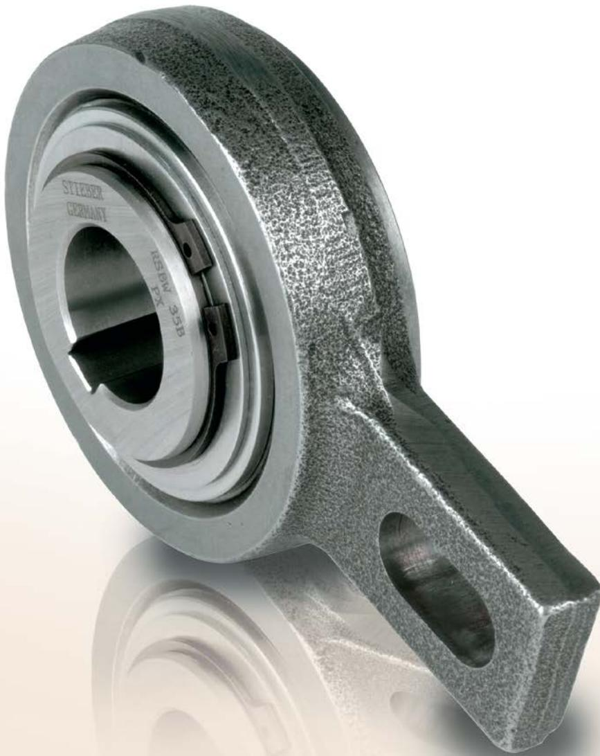
El modelo RSBW es una rueda libre DC de tipo cuña. Es autónomo, está centrado por rodamientos planos para velocidades de rotación bajas y está sellado mediante juntas tóricas apantalladas.
