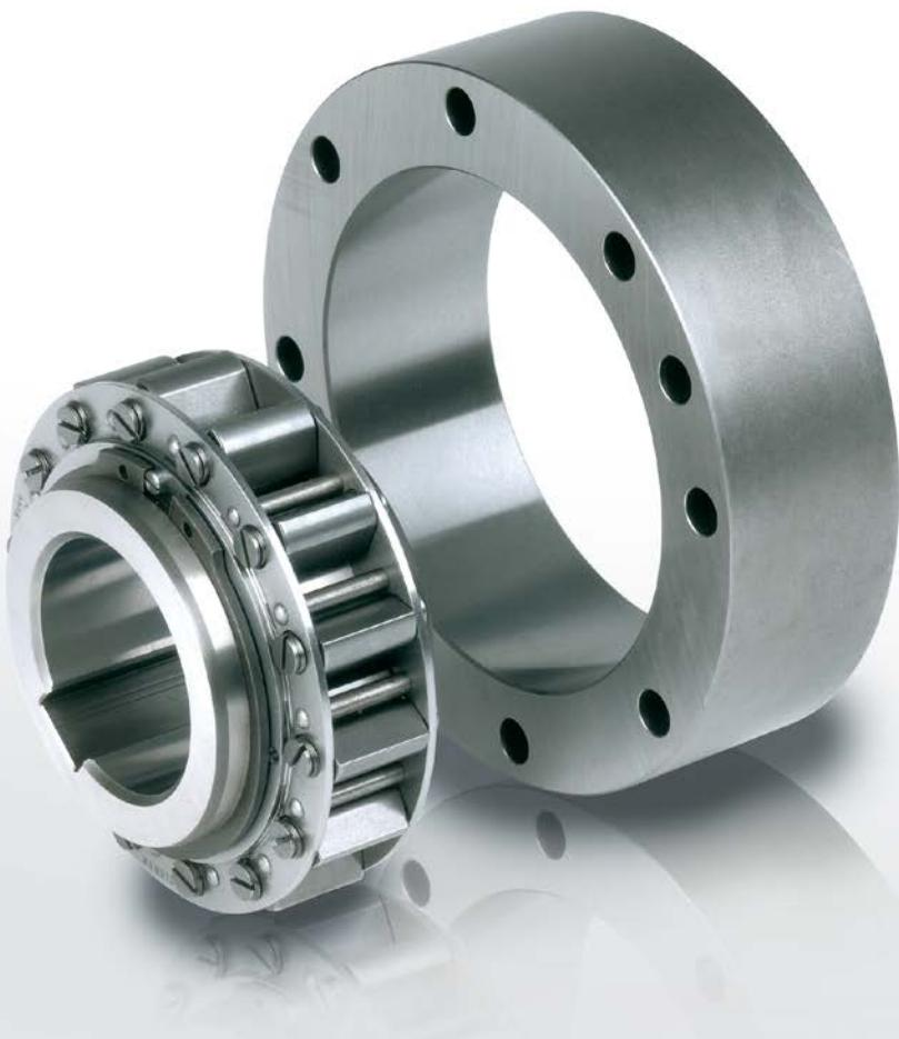
El modelo RSCI es una rueda libre de tipo cuña de elevación por fuerza centrífuga, con rotación de la pista interna. Solo la pista interna se ha diseñado para rodar a rueda libre. No es un modelo autónomo.
