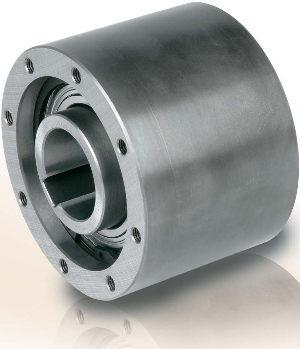
El modelo SMZ es una rueda libre de tipo cuña sellada, que se coloca sobre dos rodamientos de la serie 60..ZZ lubricados con grasa. Las unidades se entregan lubricadas con grasa y listas para la instalación. Las unidades SMZ se han diseñado como unidades multiusos que pueden utilizarse en varias aplicaciones. En la siguiente página se
