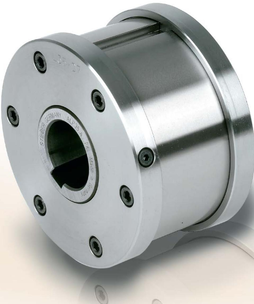
Le modèle ALP..F7D7 est une roue libre à rouleaux, étanche et autonome, autocentrée par deux roulements série 160.. qui n'est pas livrée lubrifiée.
