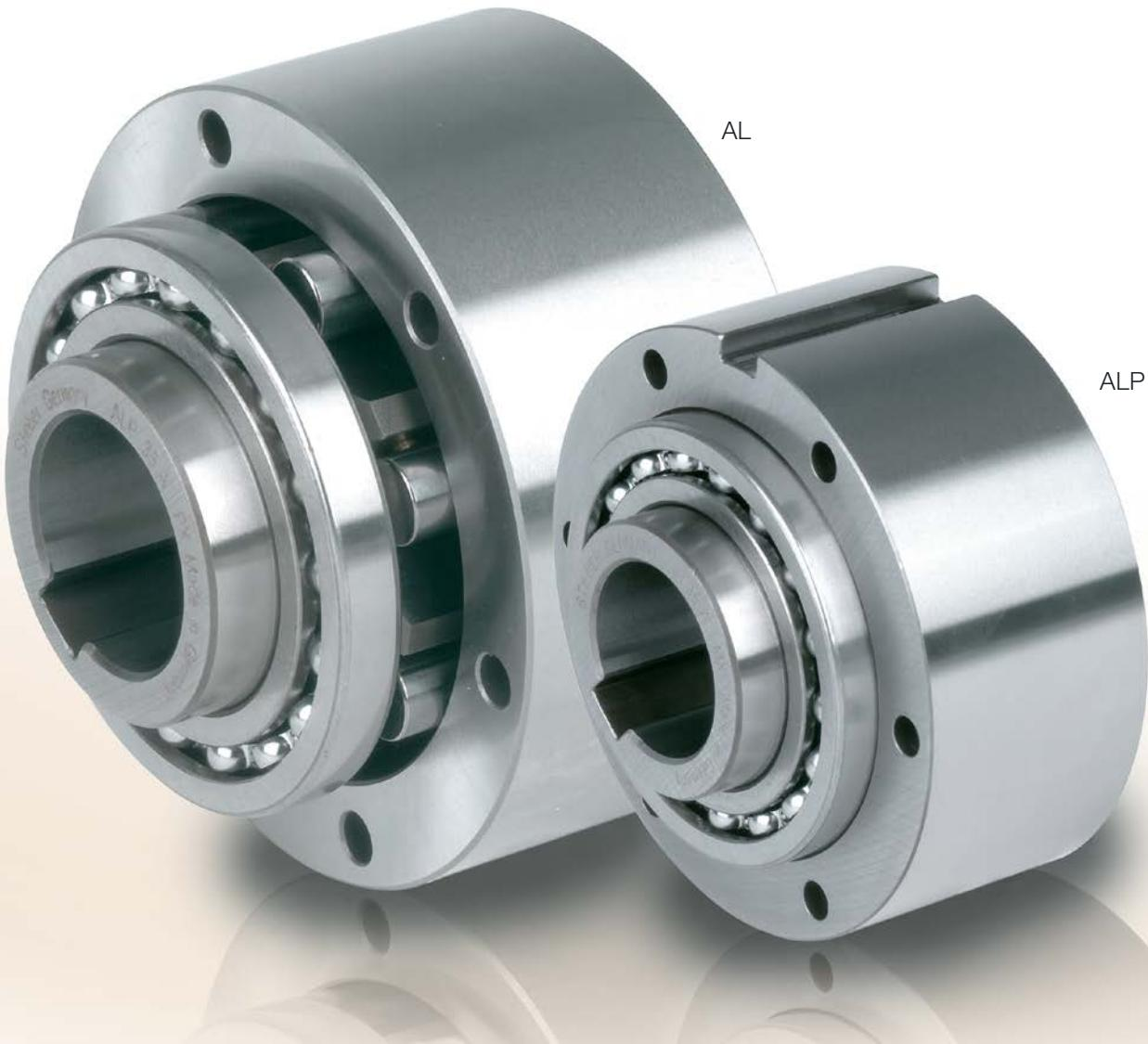
Les modèles AL, ALP sont des roues libres à rouleaux. Ce sont des modules de base autocentrés par deux roulements série 160.. En standard, une lubrification à l'huile est à prévoir.
