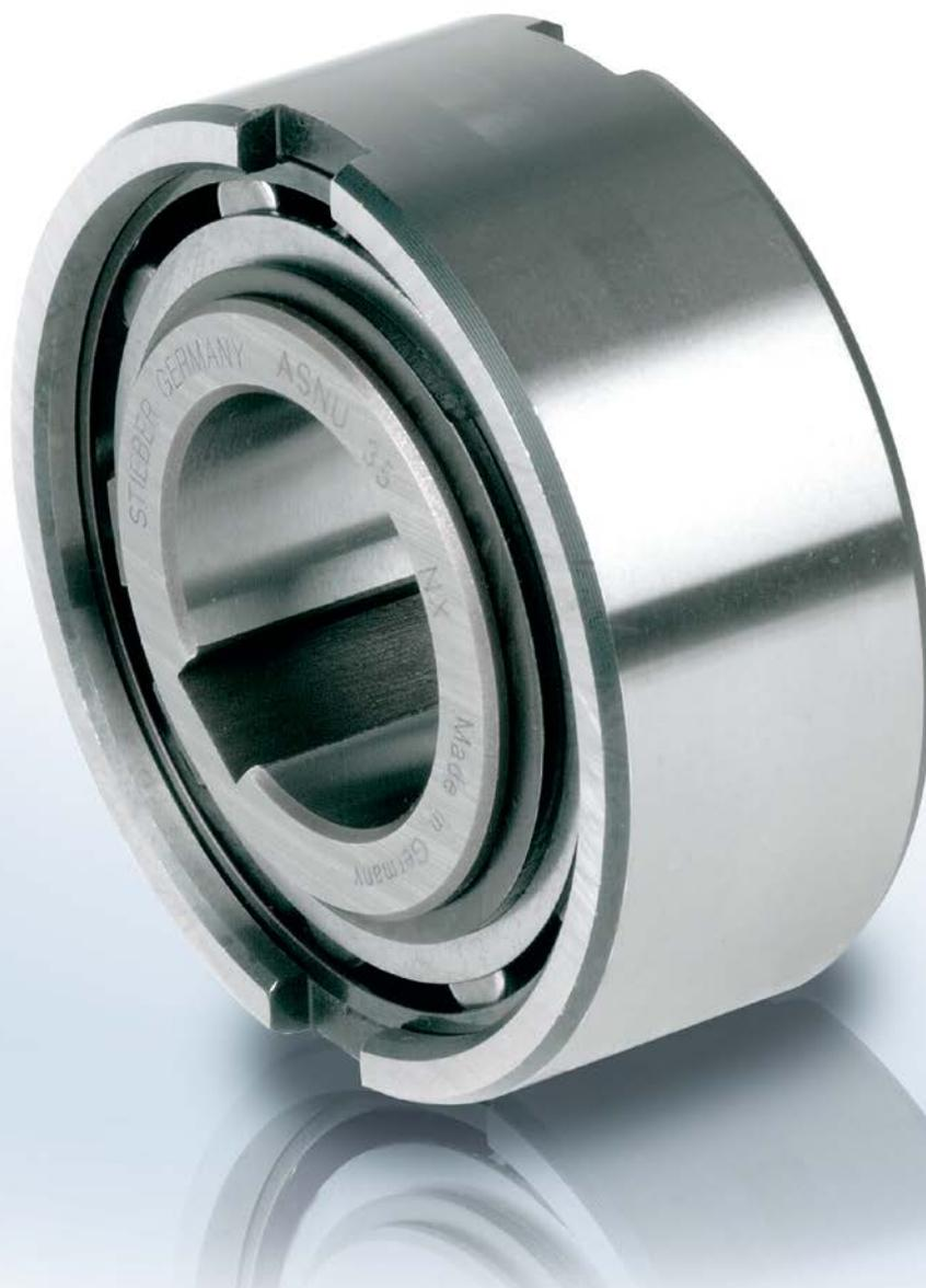
Le modèle ASNU est une roue libre à rouleaux non auto-centrée. Il est nécessaire de l'intégrer dans un montage fournissant roulements, lubrification et étanchéités.
