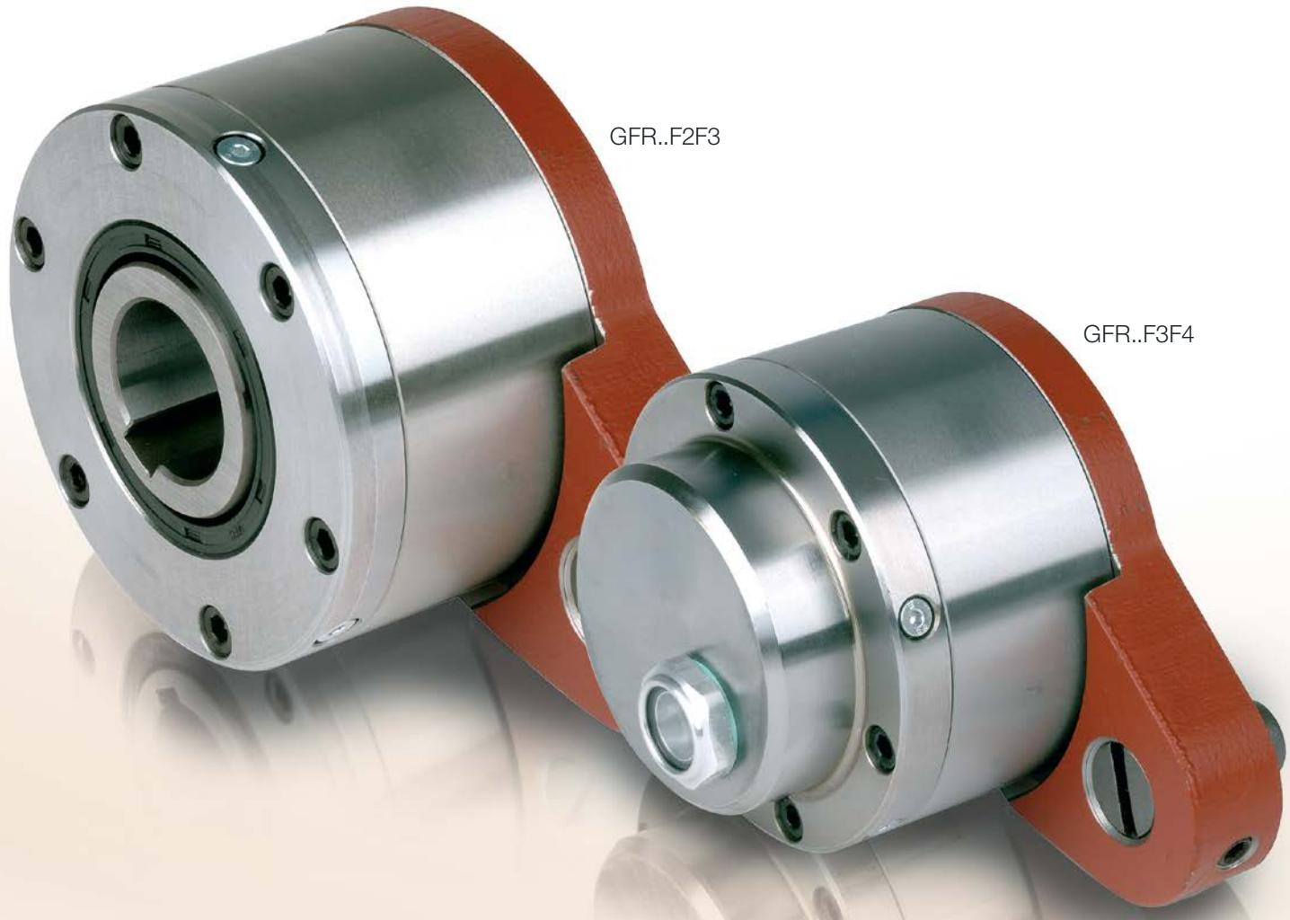
Le modèle GFR..F2F3/F3F4 est une roue libre à rouleaux, étanche et autonome, autocentée par deux roulements série 160..
