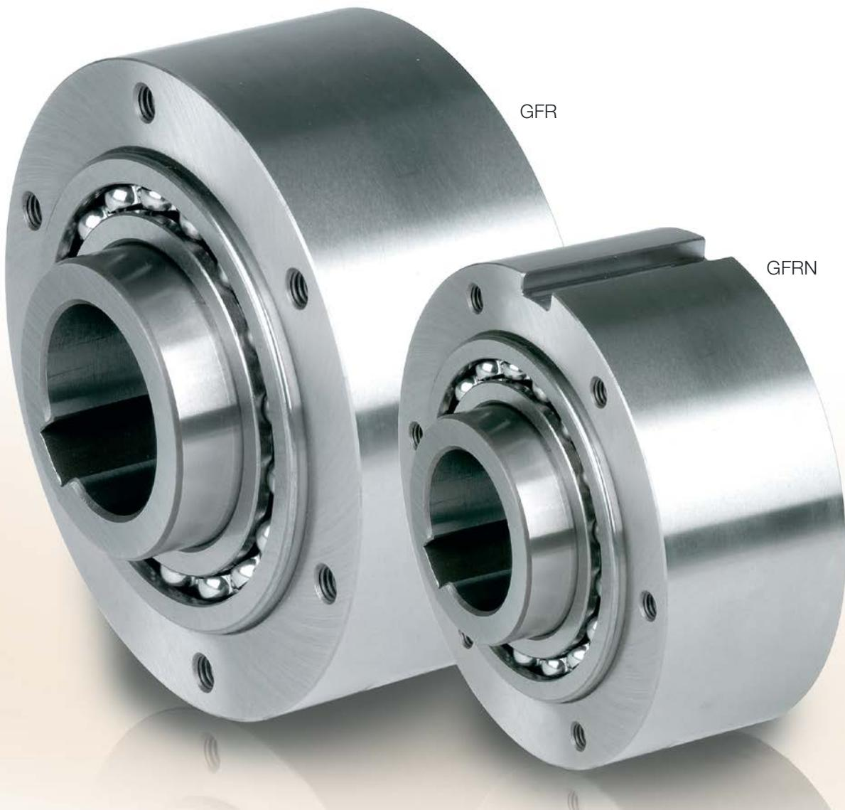
Les modèles GFR, GFRN sont des roues libres à rouleaux. Ce sont des modules de base autocentrés par deux roulements série 160.. En standard, une lubrification à l'huile est à prévoir.
