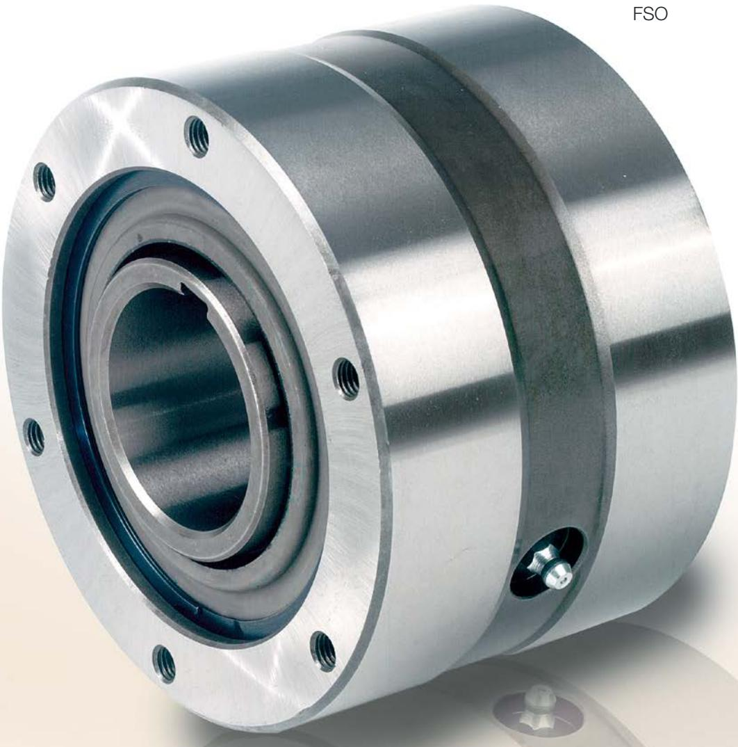
Les modèles FS, FSO et HPI 750 à 1027 sont des roues libres à cames, étanches et autonomes, autocentrées et lubrifiées à l'huile ou à la graisse selon le modèle.
