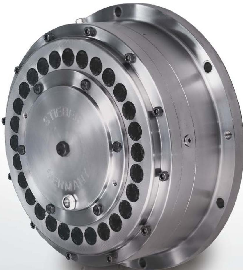
Le modèle RDBK est un antidévireur hautes vitesses à dégagement centrifuge des cames et équipé en outre d'un système de limitation du couple de retour. Voir le modèle RSCI pages 72 à 75 pour complément d'informations sur cette technologie.
