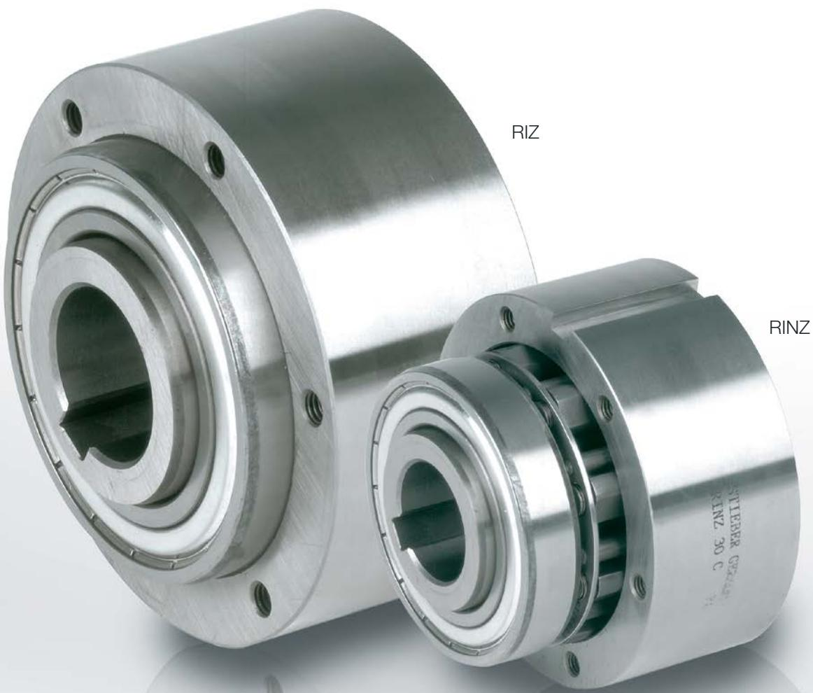
Les modèles RIZ, RINZ sont des roues libres à cames à dégagement centrifuge par rotation de la bague intérieure qui seule est prévue pour tourner en roue libre dans des applications d'antidévireur ou d'embrayage à dépassement.
