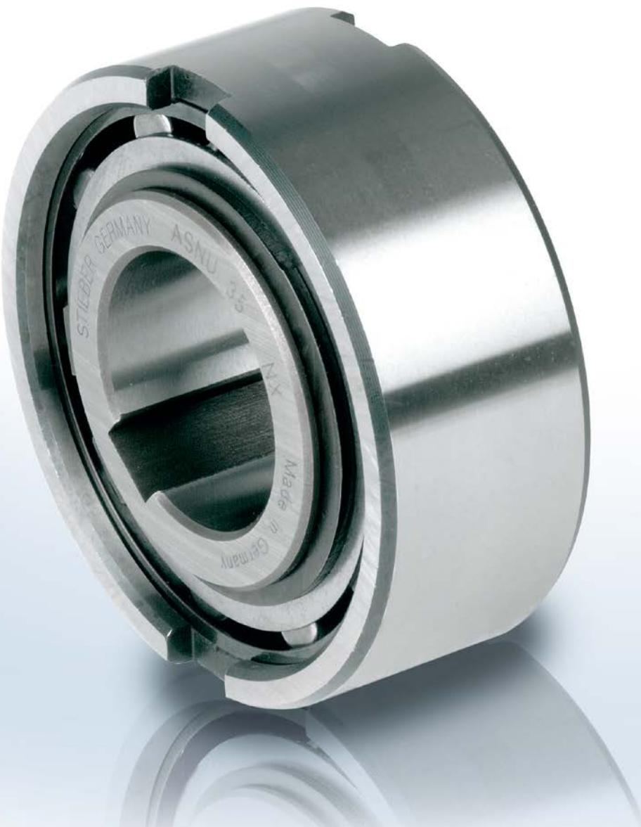
Le modèle ASNU est une roue libre à rouleaux non autocentré. Il est nécessaire de l'intégrer dans un montage fournissant roulements, lubrification et étanchéités.
