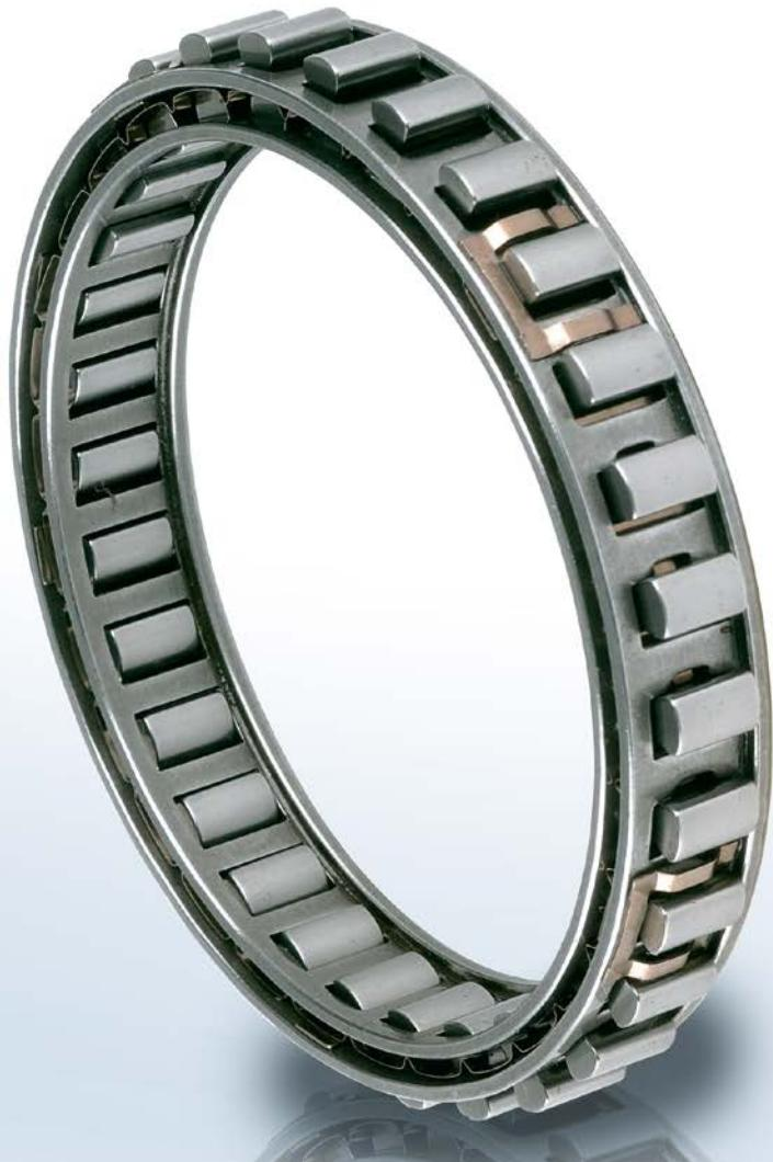
Le modèle DC est une cage roue libre à cames sans bagues ni intérieure ni extérieure. Il est nécessaire de l'intégrer dans un montage fournissant pistes ou bagues, roulements, lubrification et étanchéités. La version-N de ce modèle accepte tous les types de lubrifiants couramment utilisés dans les transmissions mécaniques.
