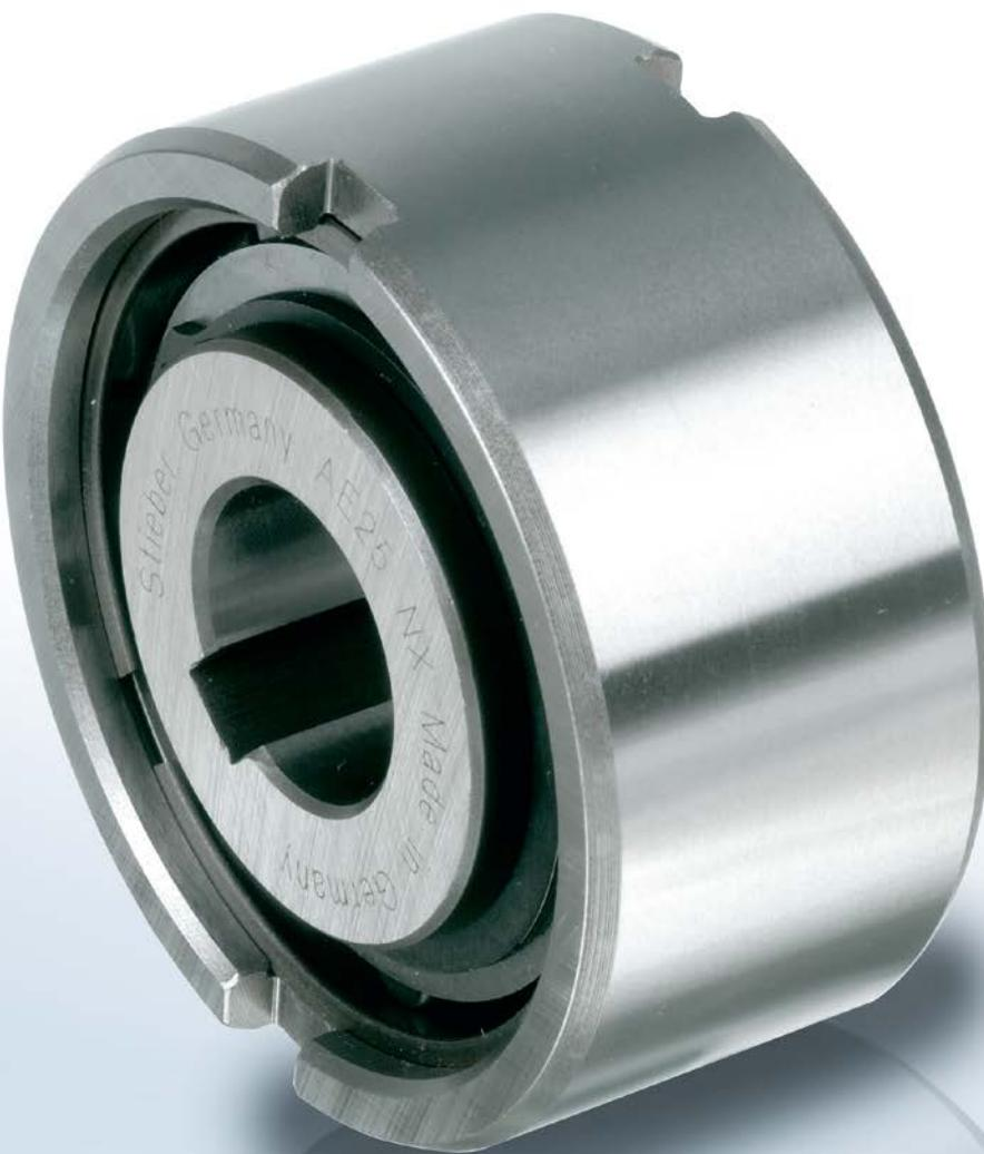
Le modèle AA est une roue libre à rouleaux non autozentrée. Il est nécessaire de l'intégrer dans un montage fournissant roulements, lubrification et étanchéités.
