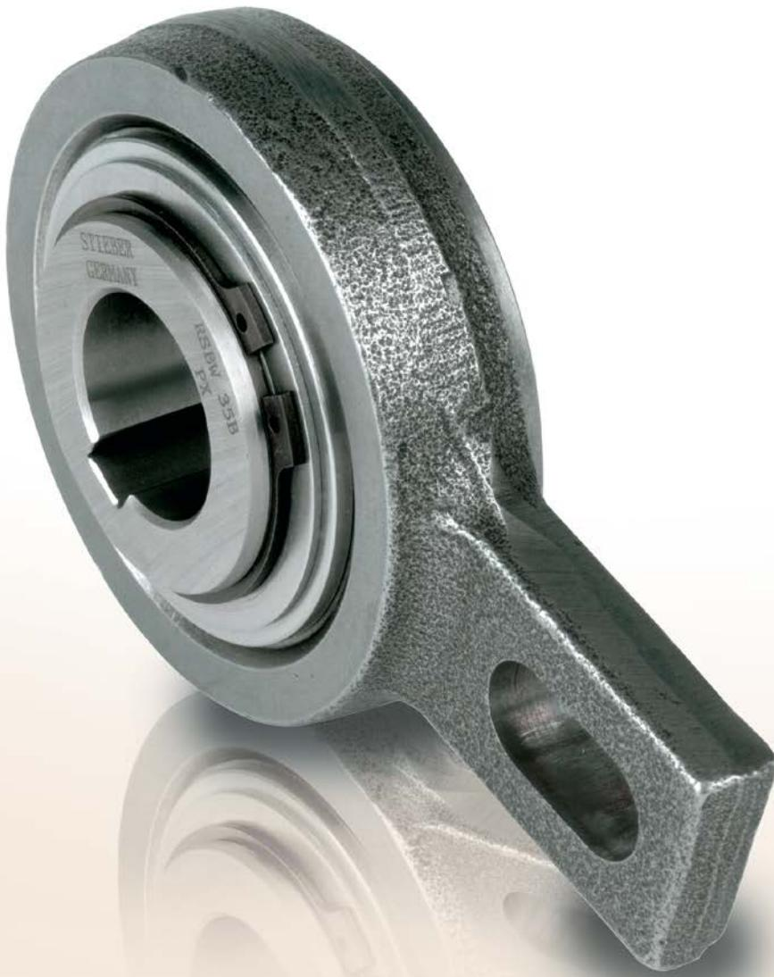
Le modèle RSBW est une roue libre à cames du type DC. C'est une version autonome, centrée par paliers lisses pour des vitesses de rotation faibles. Des joints toriques assurent l'étanchéité.
