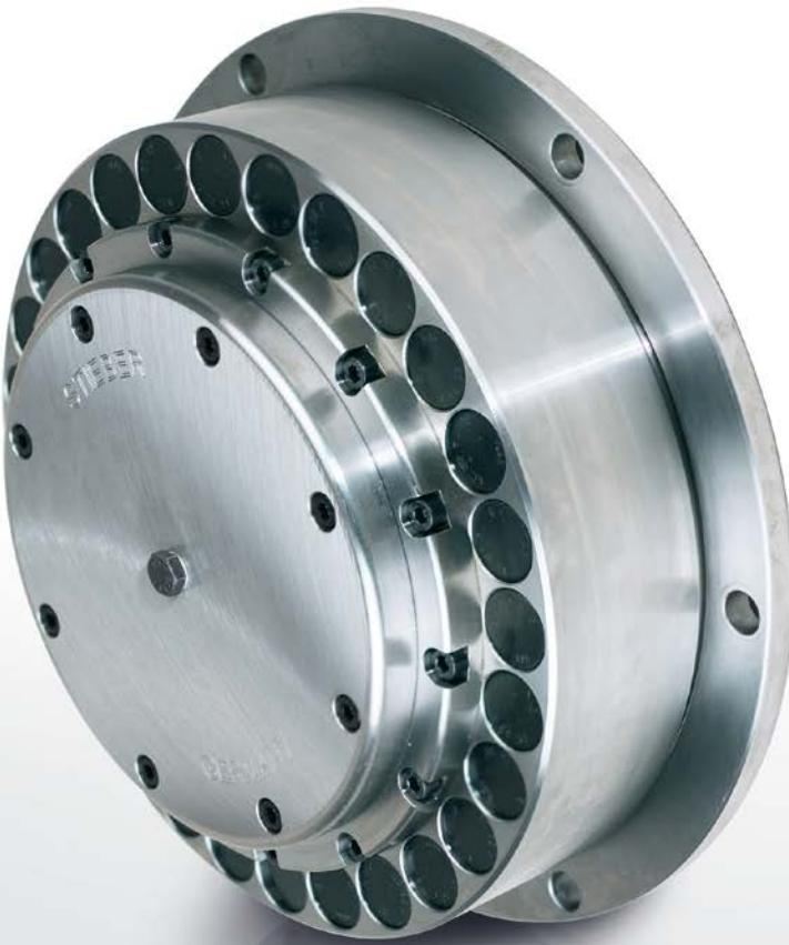
Les modèles RSRV et RSRT sont des antidévireurs hautes vitesses à dégagement centrifuge des cames équipés en outre d'un système de limitation du couple de retour. Voir le modèle RSCI pages 72 à 75 pour complément d'informations sur cette technologie.
