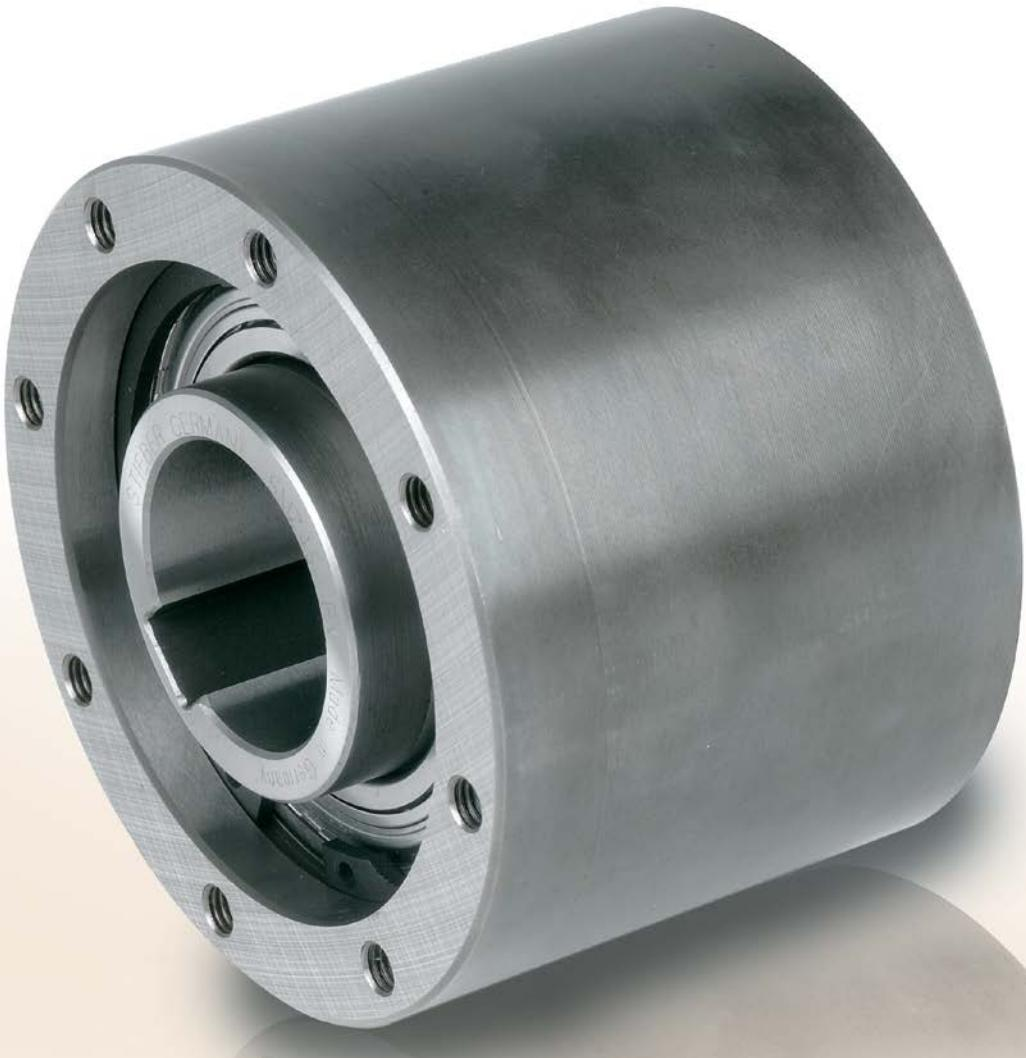
Le modèle SMZ est une roue libre à cames, étanche et autonome, centrée par deux roulements protégés de la série 60..ZZ.
