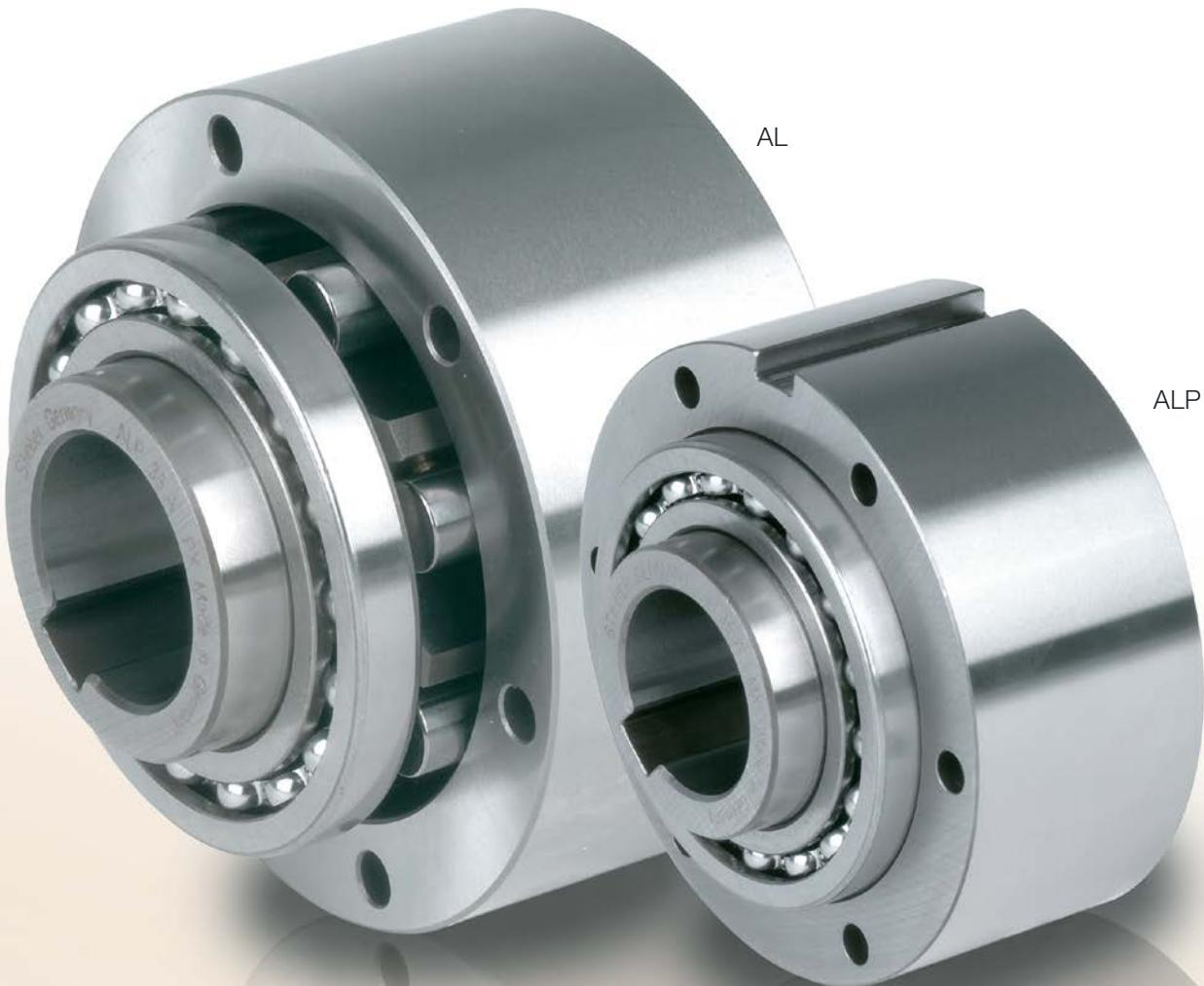
Os tipos AL e ALP são rodas livres tipo rolo. Estas unidades fazem parte do sistema modular da Stieber. São suportadas por mancais, utilizam dois mancais série 160.. e exigem lubrificação com óleo. Estas unidades podem ser usadas em projetos que fornecem vedação e lubrificação com óleo, conforme mostrado no exemplo a seguir.
