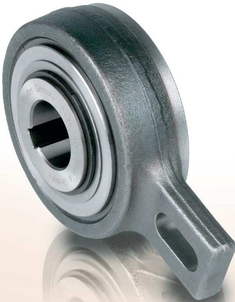
O tipo AV é um contra recuo tipo rolo. É autocontida, centralizada por mancais deslizantes para baixas velocidades de rotação e vedada com anéis de labirinto metálicos protegidos.
