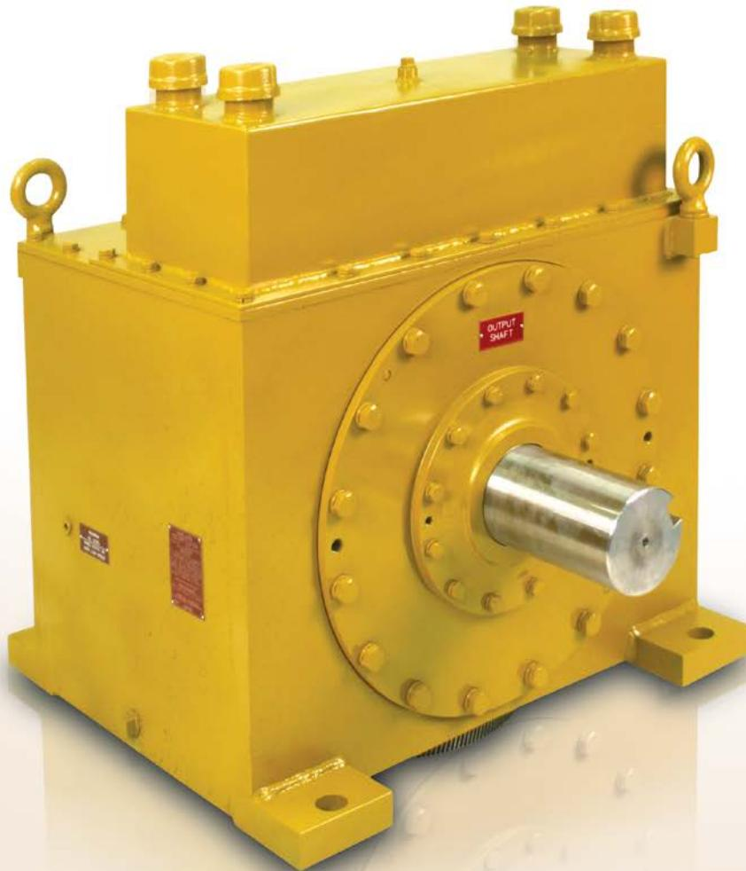
O tipo CEUS do grupo de produtos CECON é uma embreagem unidirecional tipo rolo com suporte por mancais e autocontida em uma caixa de ferro fundido. A lubrificação padrão é óleo.
