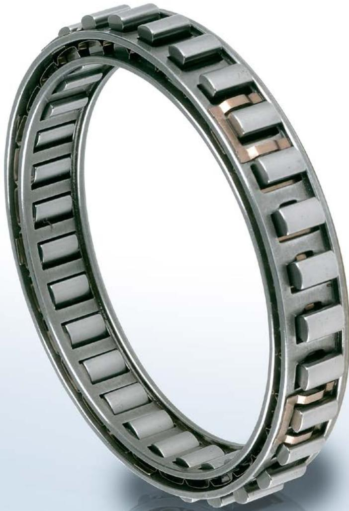
O tipo DC é uma carcaça de roda livre tipo sprag de expansão sem cubos ou capas. Deve ser instalado em um design que forneça as cubos, com suporte por mancais para cargas axiais e radiais, lubrificação e vedação. O tipo DC, versão N, aceita todos os tipos de lubrificantes usados atualmente em equipamentos de transmissão de energia.
