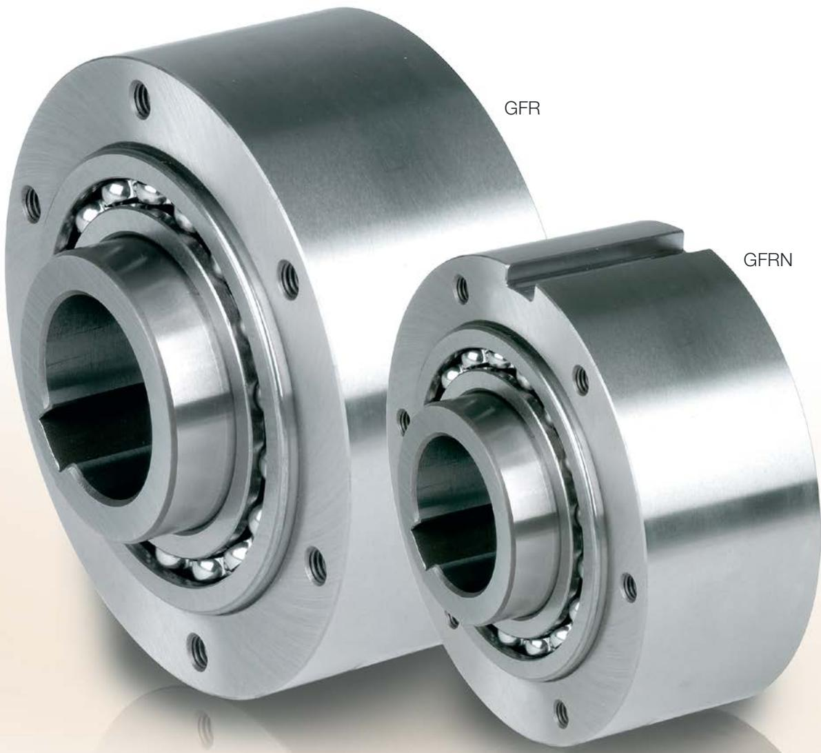
Os tipos GFR e GFRN são rodas livres do tipo rolo. Estas unidades fazem parte do sistema modular da Stieber. São suportadas por mancais, utilizam dois mancais série 160.. e exigem lubrificação com óleo. Estas unidades podem ser usadas em projetos que fornecem vedação e lubrificação com óleo, conforme mostrado no exemplo a seguir. Os mancais não devem ser tensionados axialmente.
