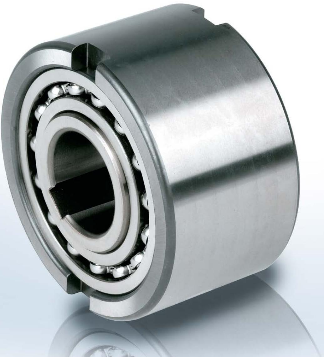
O tipo NFR é um contra recuo tipo rolo com suporte por mancais e sem qualquer tipo de vedação. A lubrificação e a vedação devem ser fornecidas pela instalação. A lubrificação padrão é óleo.
