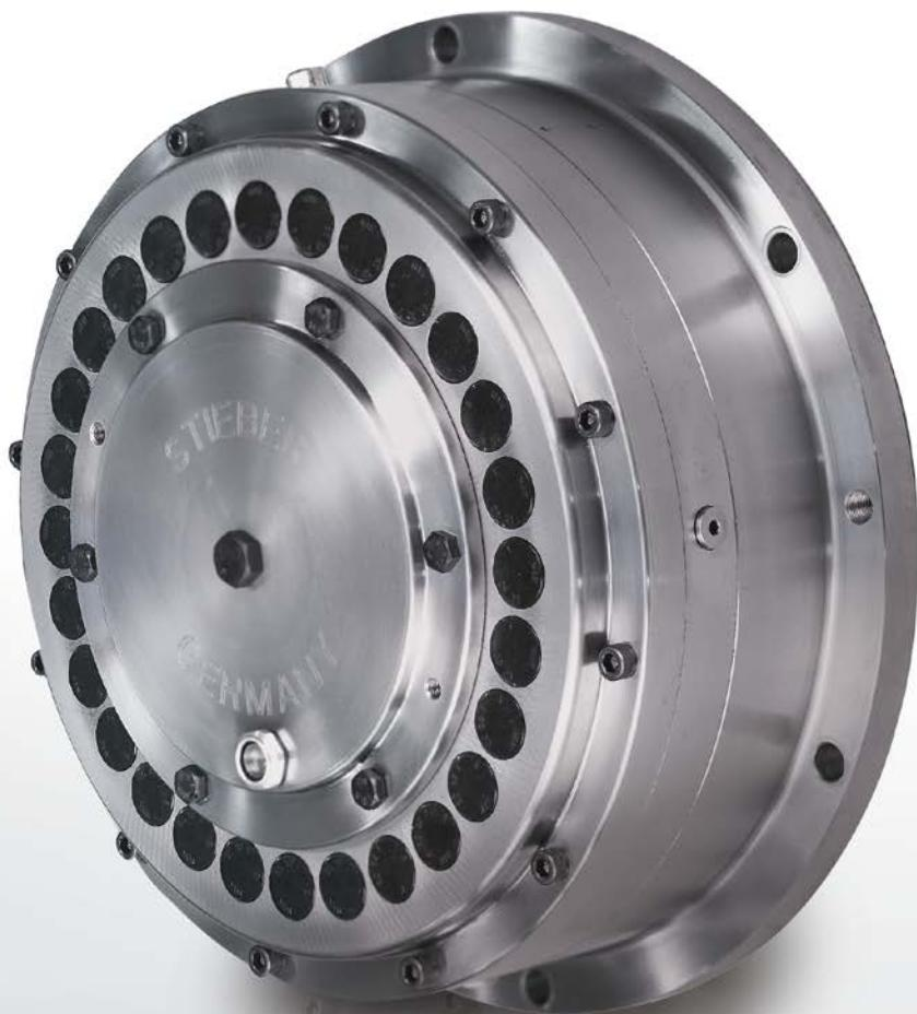
O tipo RDBK é um backstop RSCI tipo sprag de expansão de alta velocidade e desengate centrífugo (consulte as páginas 72 a 75) equipado com um limitador de torque integral. Este último limita o torque transmissível do backstop a um valor que é configurado na fábrica segundo o pedido do cliente.
