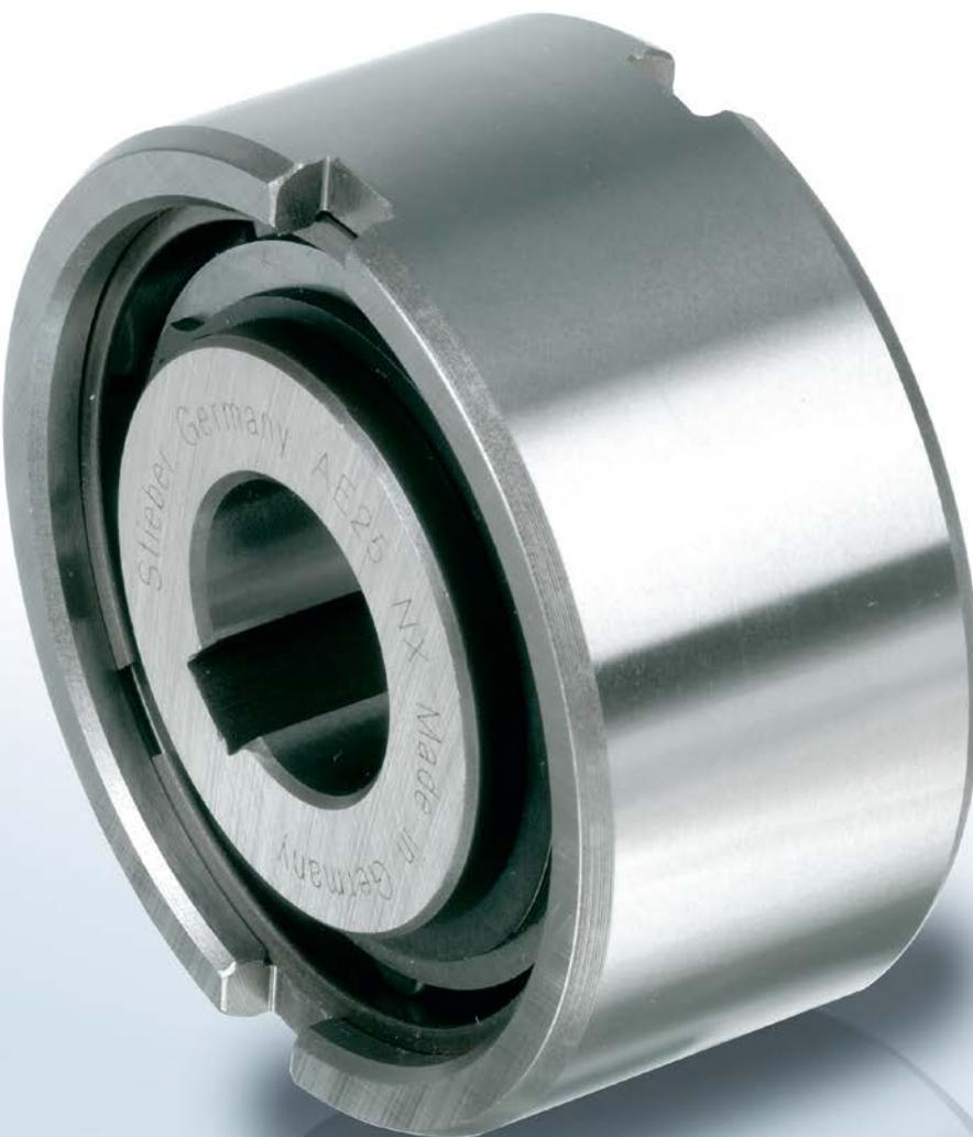
O tipo AA é um contra recuo tipo rolo sem suporte por mancais. Mancais são necessários para suportar cargas axiais e radiais. A lubrificação e a vedação devem também ser fornecidas pela instalação.
