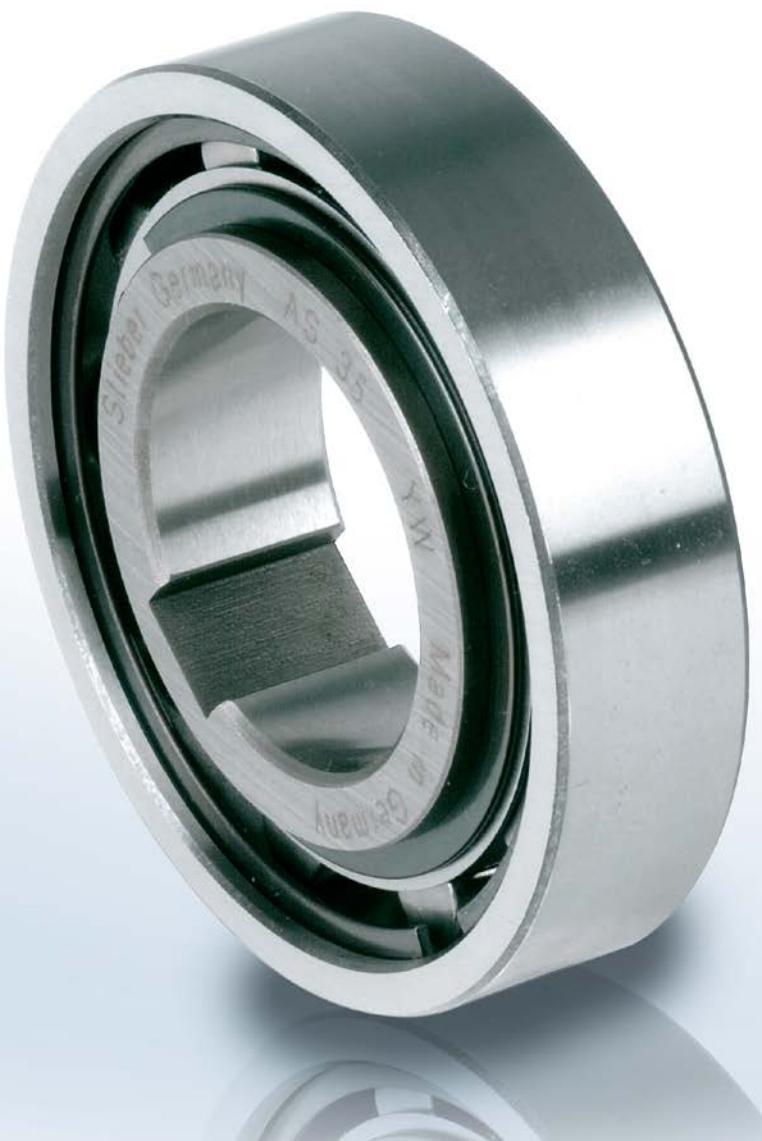
O tipo AS é um contra recuo tipo rolo sem suporte por mancal. Mancais são necessários para suportar cargas axiais e radiais. A lubrificação e a vedação devem também ser fornecidas pela instalação. As dimensões externas nominais são as mesmas dos mancais de esferas da série 62.
