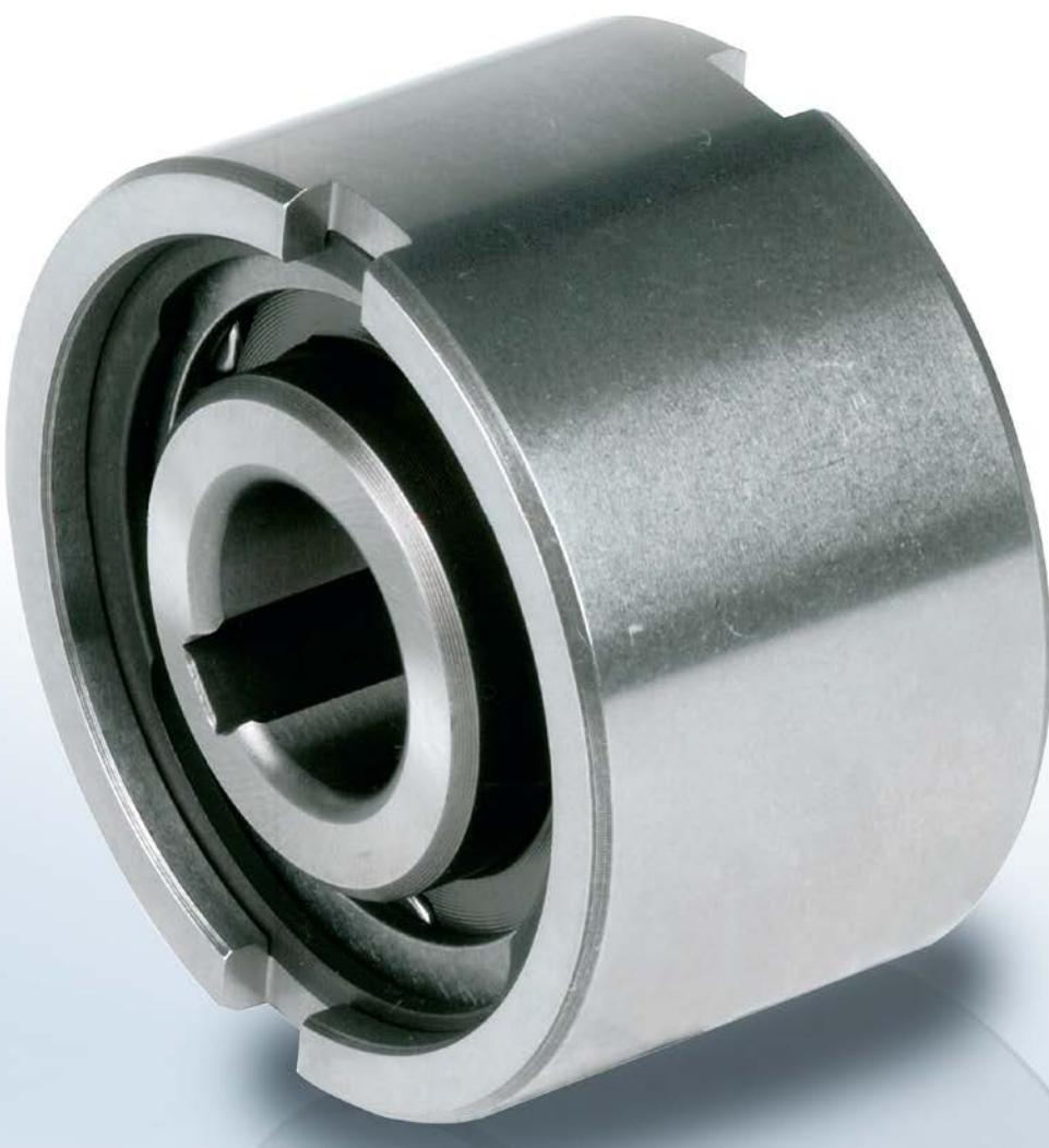
O tipo NF é um contra recuo tipo rolo sem suporte por mancais. Mancais são necessários para suportar cargas axiais e radiais. A lubrificação e a vedação devem também ser fornecidas pela instalação.
