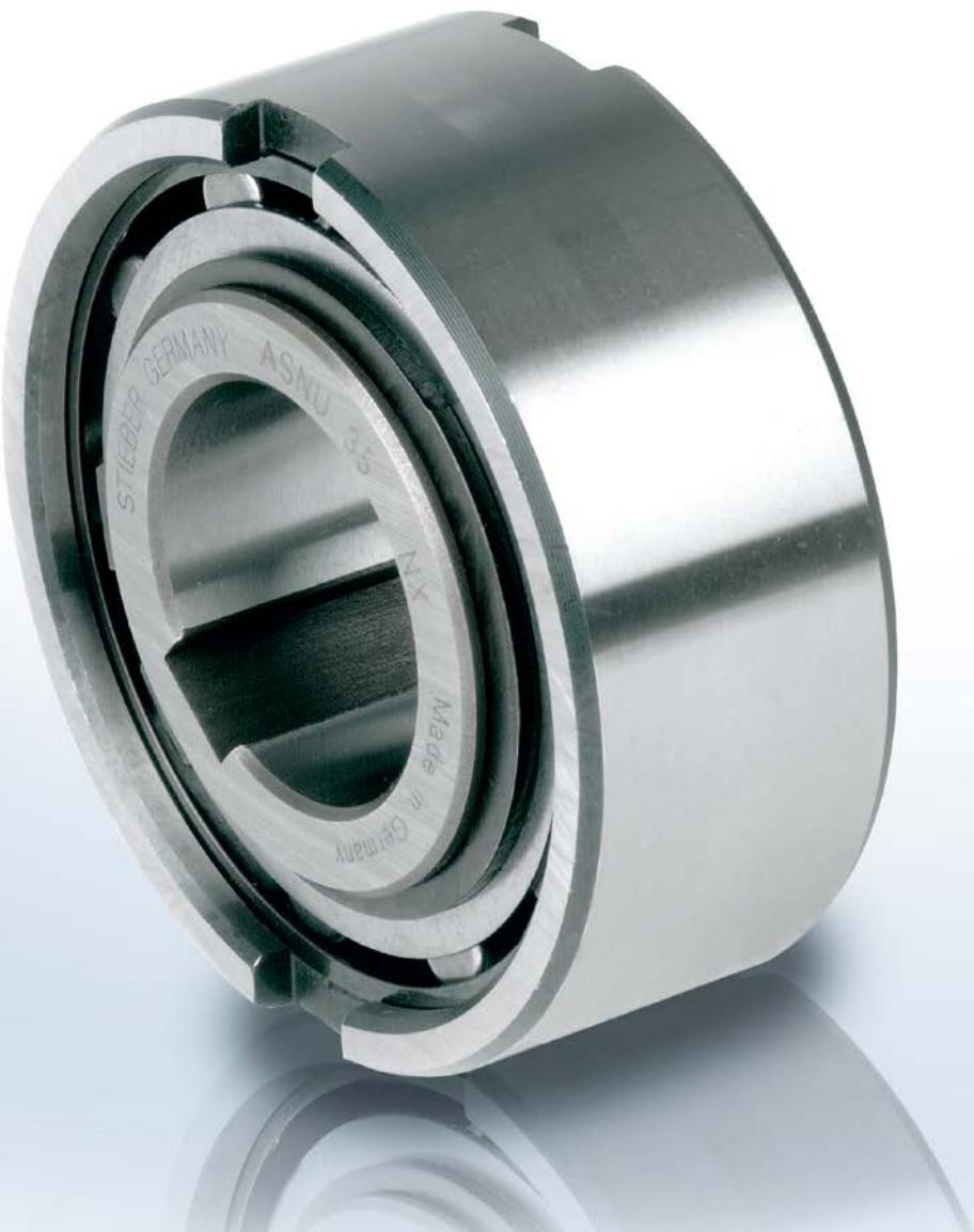
O tipo ASNU é um contra recuo tipo rolo sem suporte por mancais. Mancais são necessários para suportar cargas axiais e radiais. A lubrificação e a vedação devem também ser fornecidas pela instalação. O diâmetro externo nominal é o mesmo de um mancal de esferas série 63.
