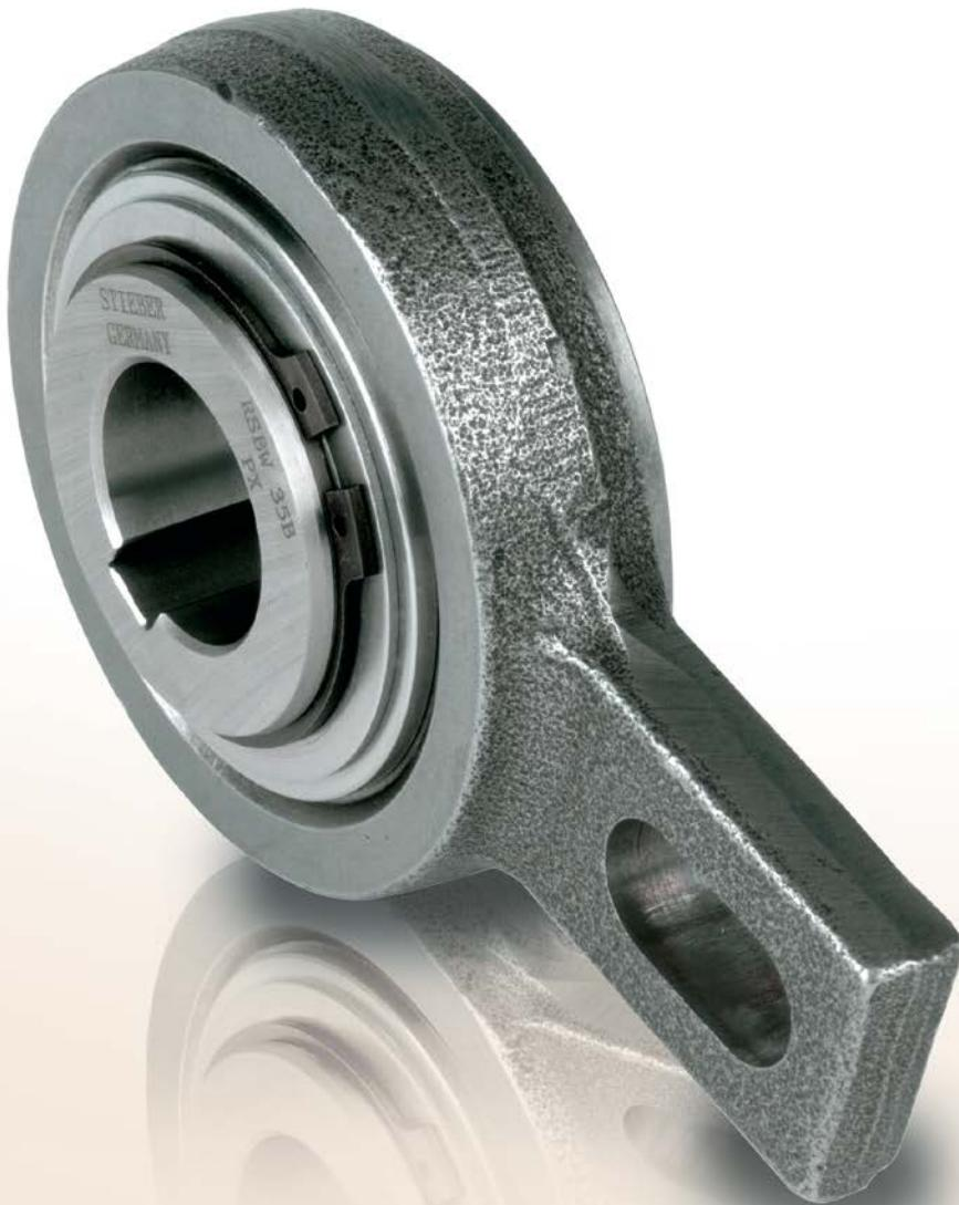
O tipo RSBW é um contra recuo tipo sprag de expansão DC. É autocontido, centralizado por mancais deslizantes para baixas velocidades de rotação e vedado com anéis O-Ring protegidos.
