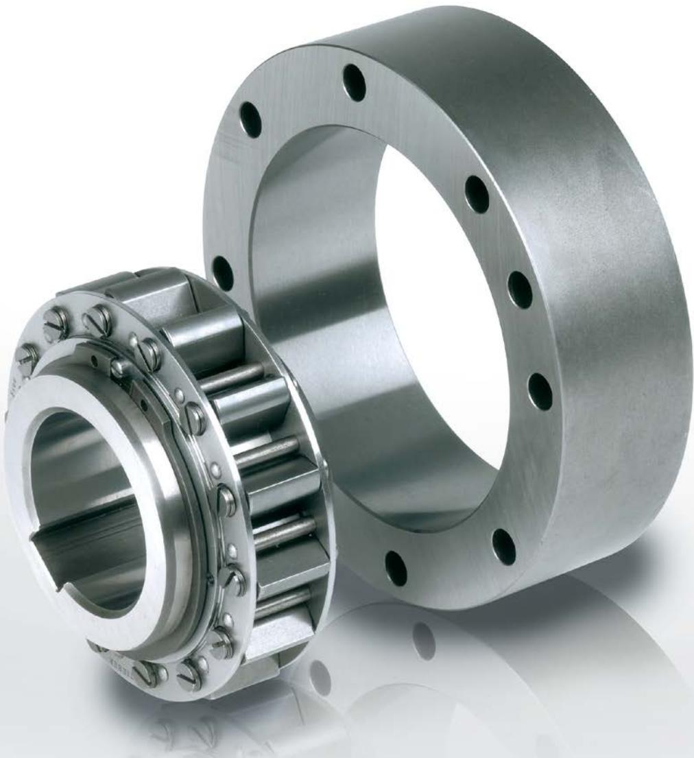
O tipo RSCI é um contra recuo tipo sprag de expansão com desengate centrífugo e rotação da cubo. Somente a cubo é projetada para girar livremente.
