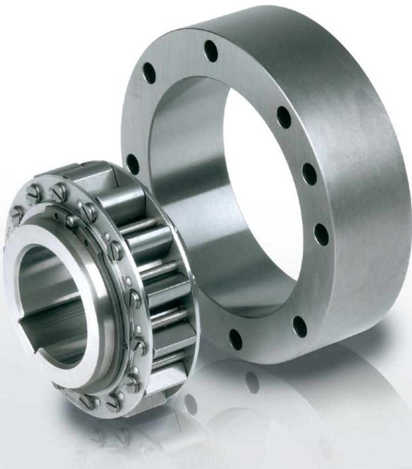
O tipo RSCI é um tipo de roda livre de sprag de expansão com desengate centrífugo e rotação da cubo. Somente a cubo é projetada para girar livremente. É do tipo sem autossuporte.
